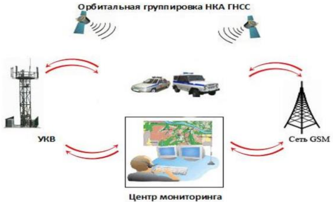
Рис. 1. Общий принцип работы НМС
