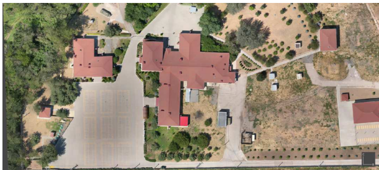
Рис. 6. Пример построения ортофотоплана и 3D-модели участка местности
