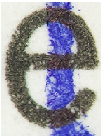
Рис. 48. Участок пересечения штрихов, нанесенных струйной печатью и пастой для шариковой ручки (струйная печать поверх пасты)
