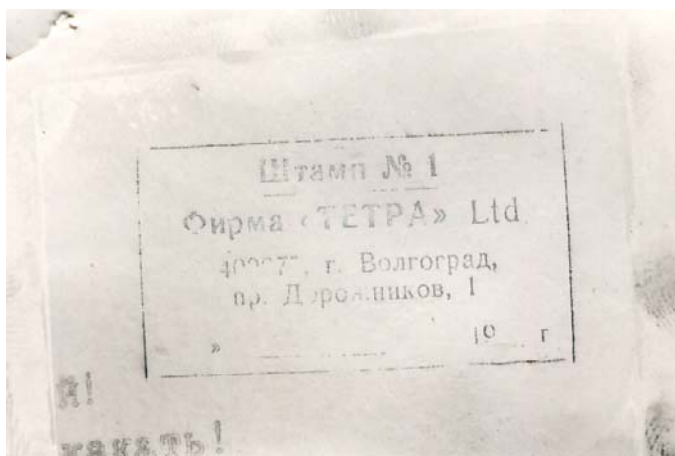
Рис. 29. Результат выявления слабовидимого оттиска штампа диффузно-копировальным методом
