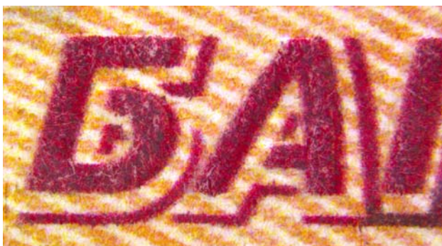
Рис. 20. Имитация металлографской печати на поддельном билете Банка России номиналом 5 000 рублей модификации 1997 г. репрографическим способом с последующим бескрасочным рельефным тиснением
