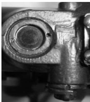
Рис. 38. Окно для зарядки люминесцентного экрана
