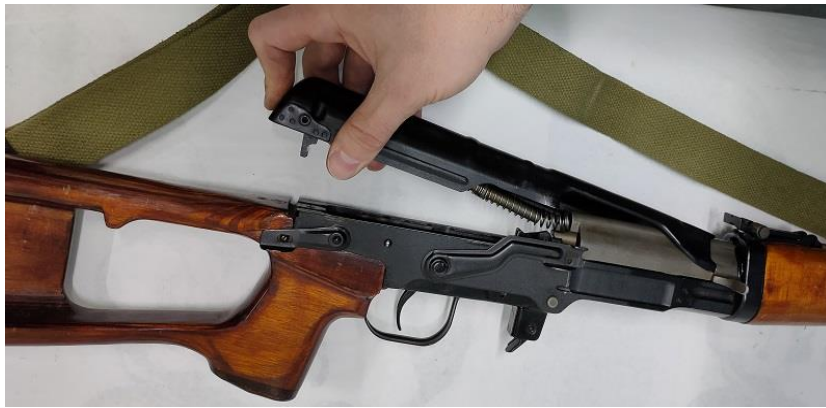
Рис. 22. Отделение крышки ствольной коробки с возвратным механизмом
