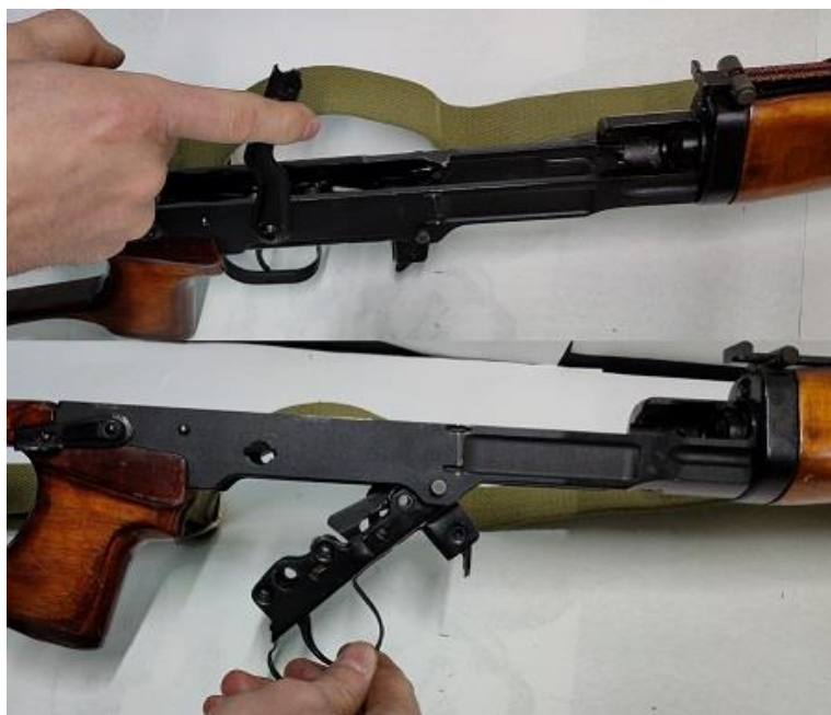
Рис. 25. Отделение ударно-спускового механизма: а – отделение предохранителя; б – отделение ударно-спускового механизма
