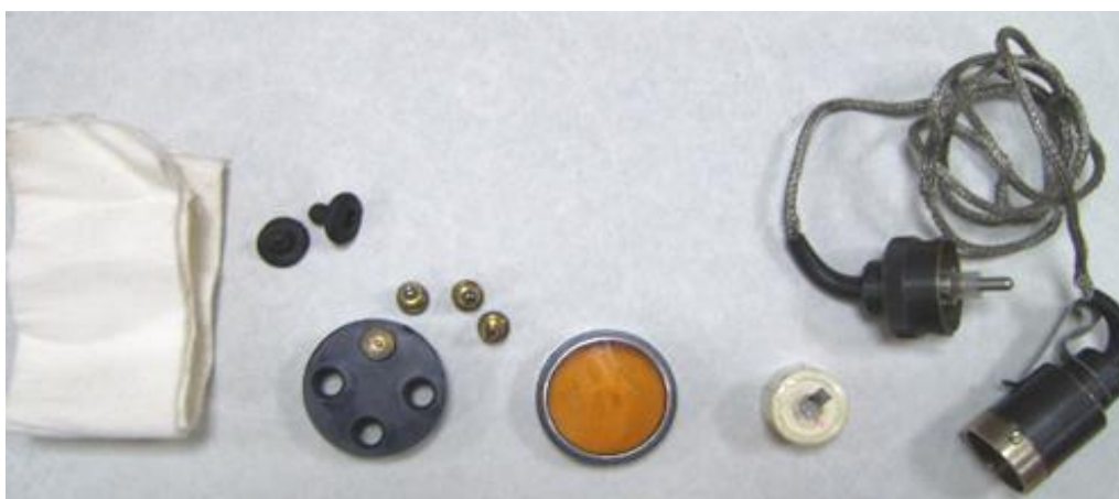
Рис. 17. Запасные части, инструмент и принадлежность к оптическому прицелу: 1 – запасные батарейки; 2 – запасные электролампочки; 3 – футляр (протектор) для запасных электролампочек; 4 – светофильтр; 5 – ключ-отвертка; 6 – резиновый колпачок на тумблер; 7 – салфетка
