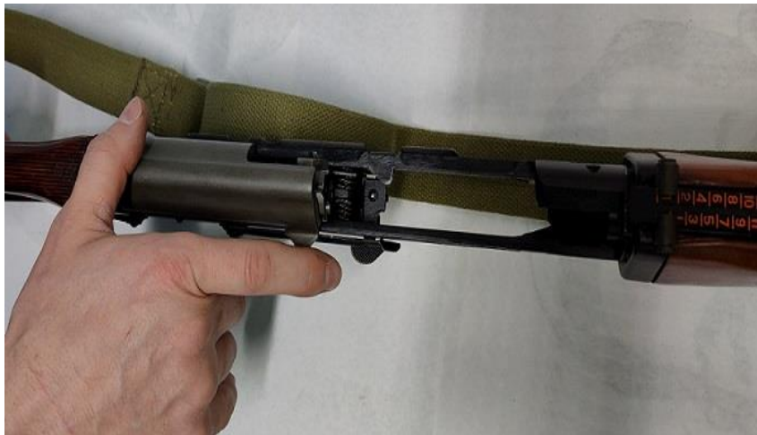
Рис. 37. Отделение затворной рамы с затвором
