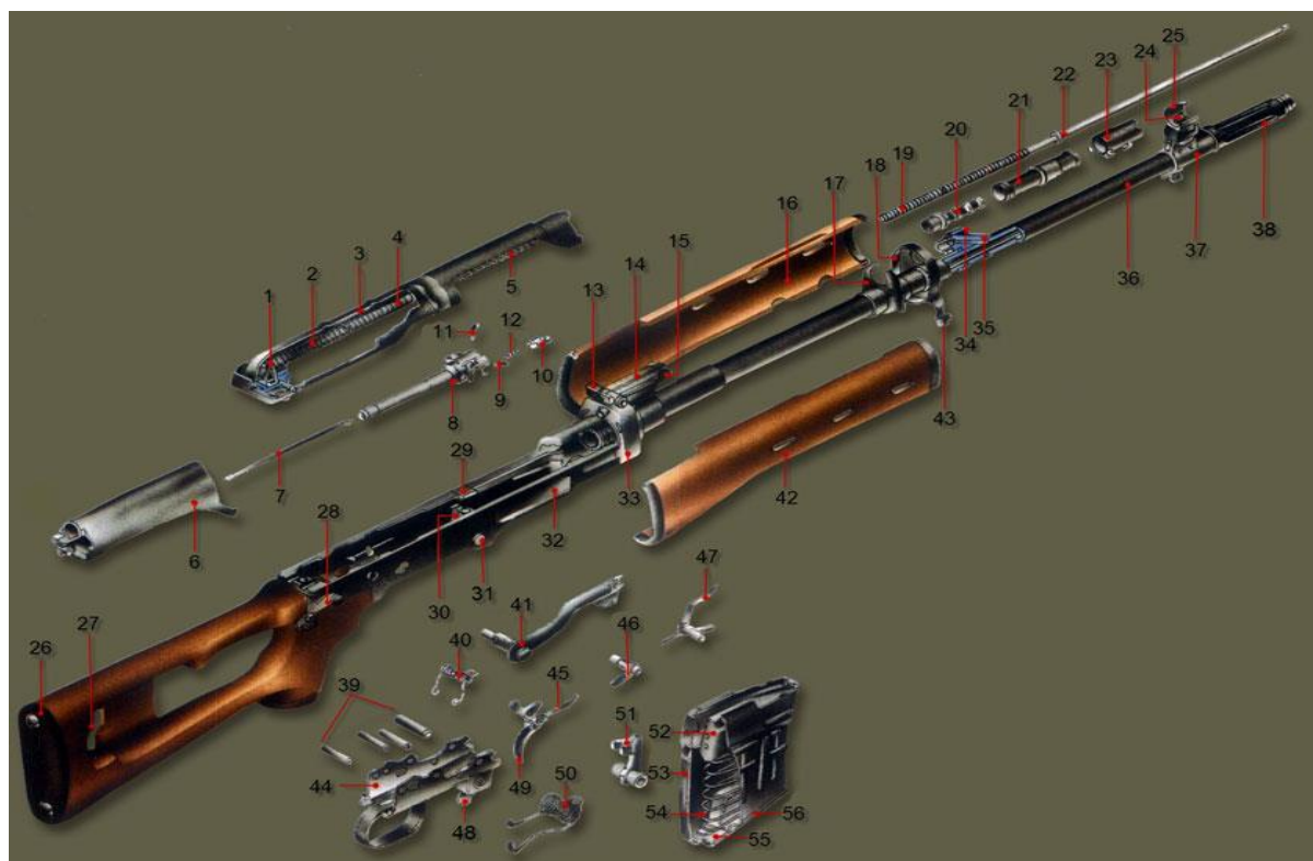
Рис. 15. Устройство частей и механизмов СВД:
