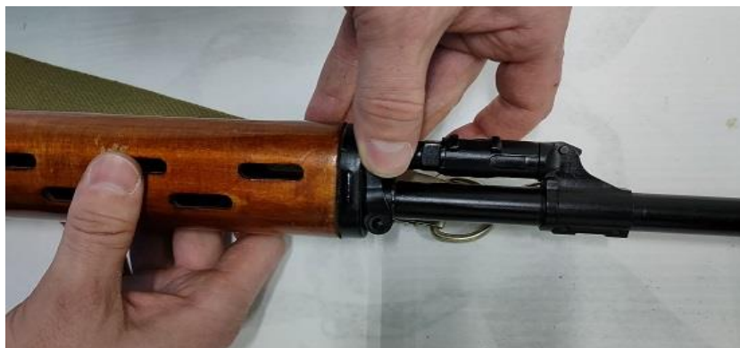
Рис. 26а. Отделение ствольных накладок: поворот замыкателя
