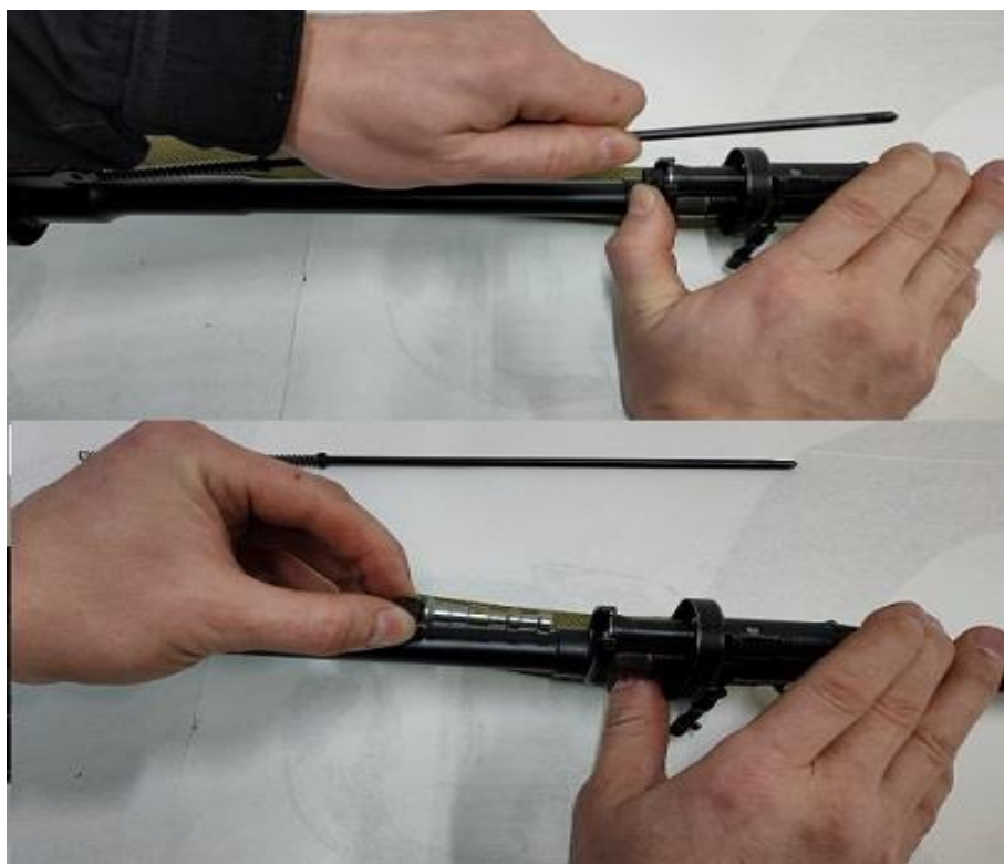
Рис. 27. Отделение газового поршня и толкателя с пружиной:
