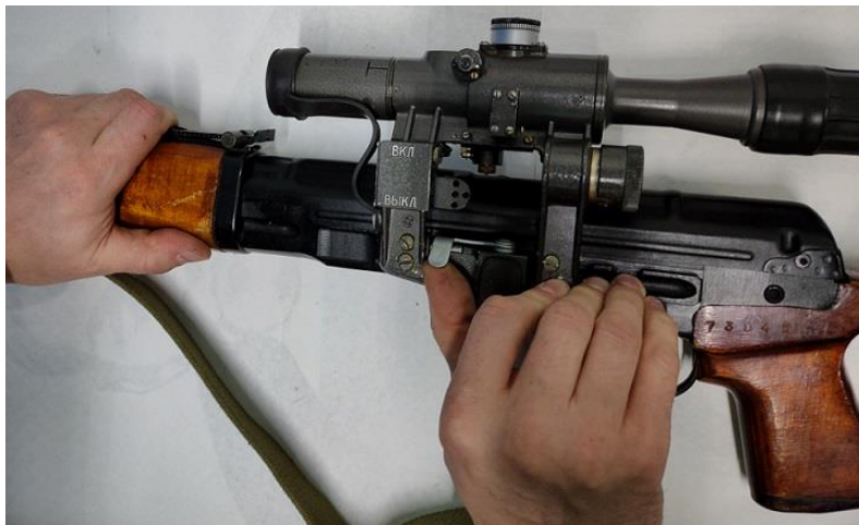
Рис. 20. Отделение оптического прицела
