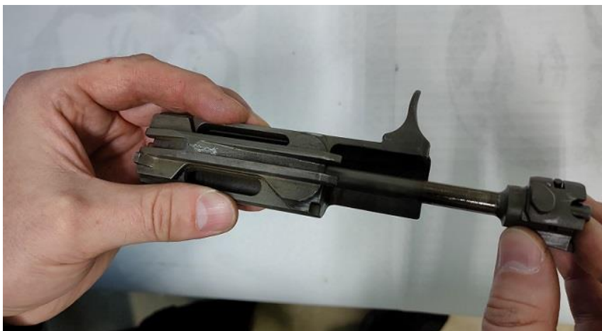
Рис. 24. Отделение затвора от затворной рамы
