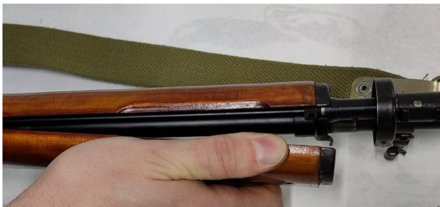
Рис. 26б. Отделение ствольной накладки
