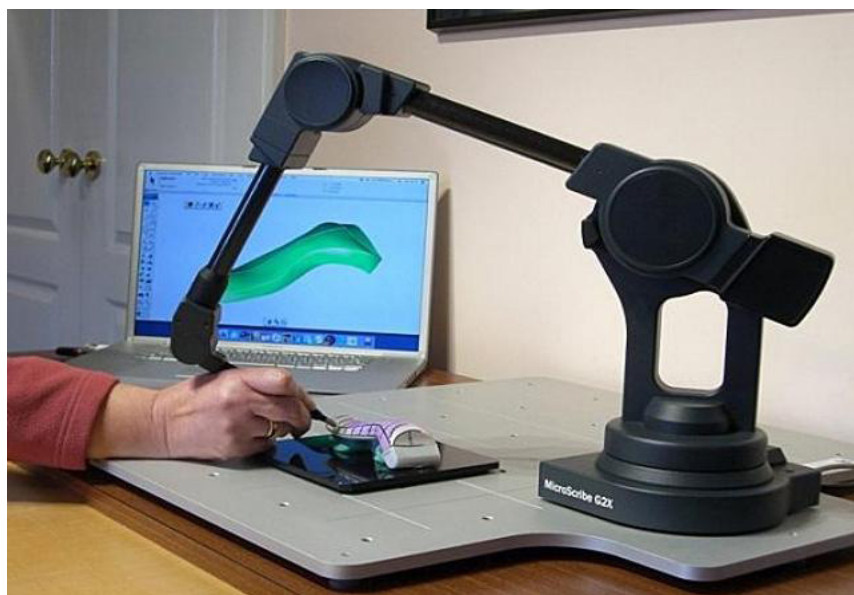
Рис. 10. Сканирование объекта с помощью контактного датчика (изображение из открытых источников)
