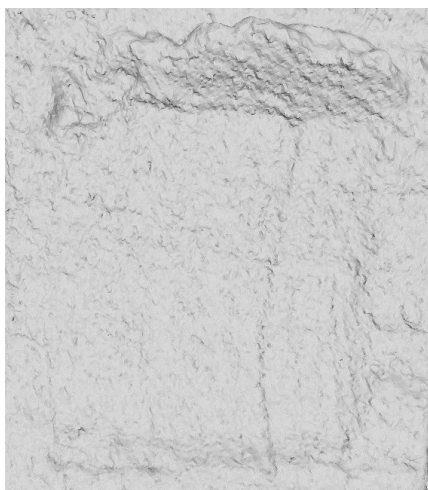
Рис. 35. Полигональная модель следа, полученная при сканировании 3D-сканером «Calibry Mini»
