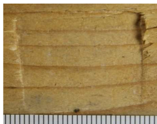
Рис. 27. След рабочей части лапчатого лова
