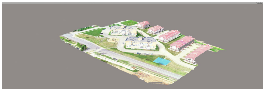
Рис. 4. 3D-модель, построенная в программном продукте ContextCapture (Bentley) с использованием полученных в ходе фотосъемки изображений и содержащихся в них метаданных
