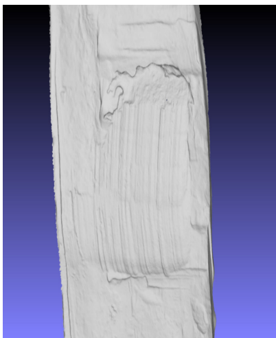
Рис. 36. Полигональная модель следа, полученная при сканировании 3D-сканером «VT Mini»
