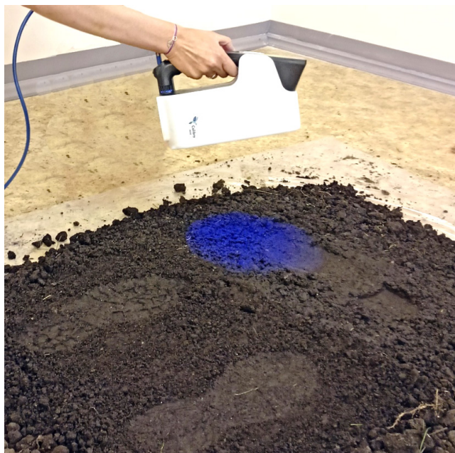
Рис. 9. Процесс сканирования следов обуви 3D-сканером «Calibry Mini» в режиме «по геометрии»
