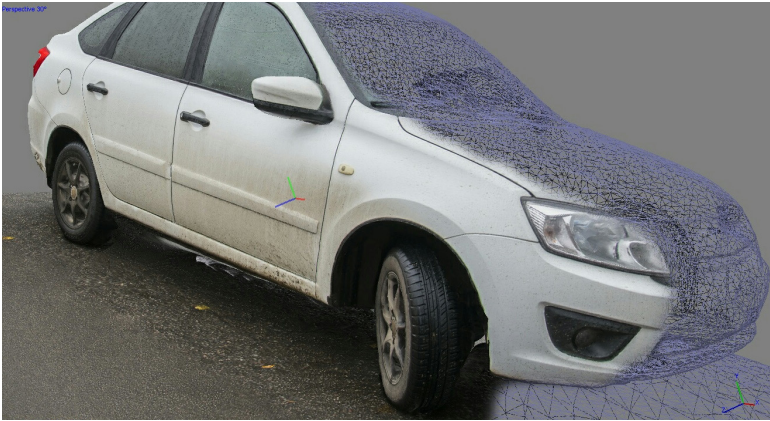
Рис. 1. 3D-модель, построенная с использованием технологии фотограмметрии (изображение из открытых источников)
