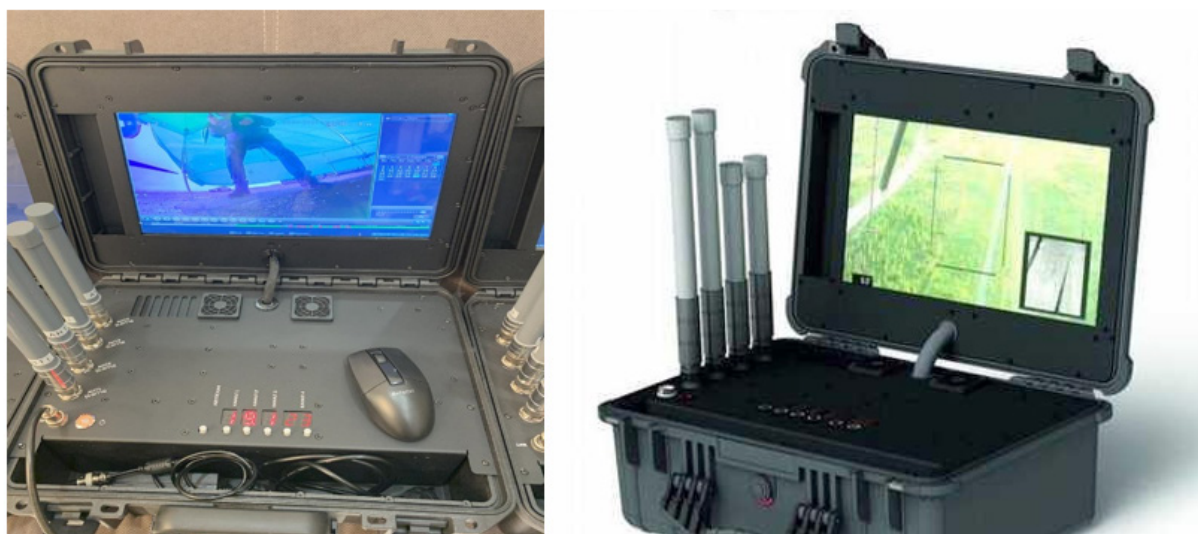
Рисунок 1. Средства обнаружения (детектирования) БВС на основе «перехвата» аналогового видеосигнала
