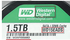
Рис. 8. Индивидуализирующие признаки накопителя на жестких магнитных дисках
