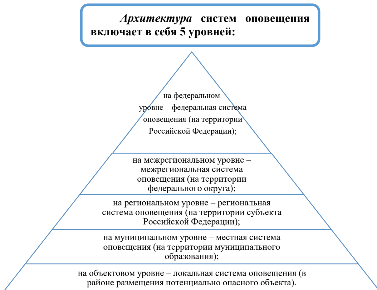
Рис. 60. Архитектура систем оповещения
