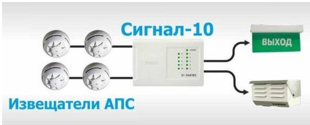
Рис. 81. Пример СОУЭ 1-го типа на базе прибора Сигнал-10.
