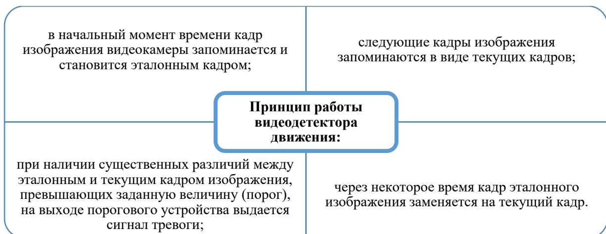
Рис. 116. Принцип работы видеодетектора движения
