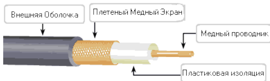
Рис. 97. Структура коаксиального кабеля
