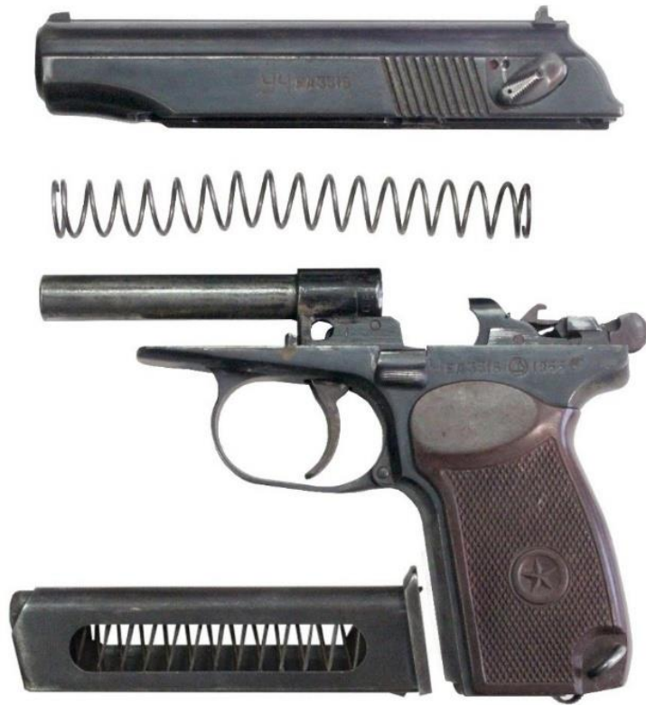
Рис. 2. Неполная разборка переделанного учебного ПМ, в конструкцию которого внесены необратимые изменения самодельным способом
