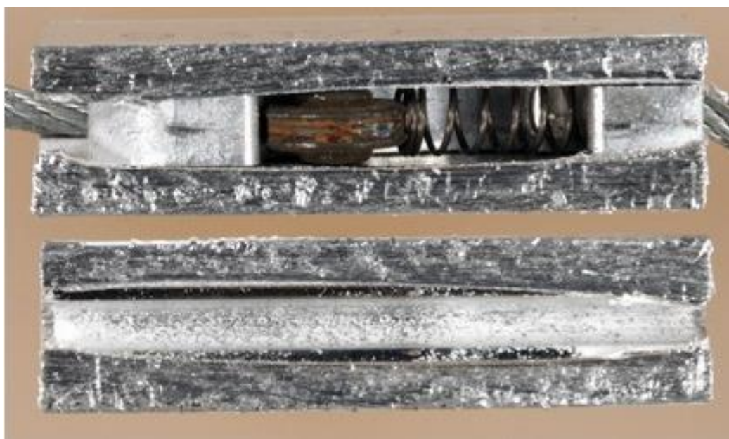
Рис. 3. Тросовое ЗПУ «Скат Универсал» после распила вдоль рабочего канала
