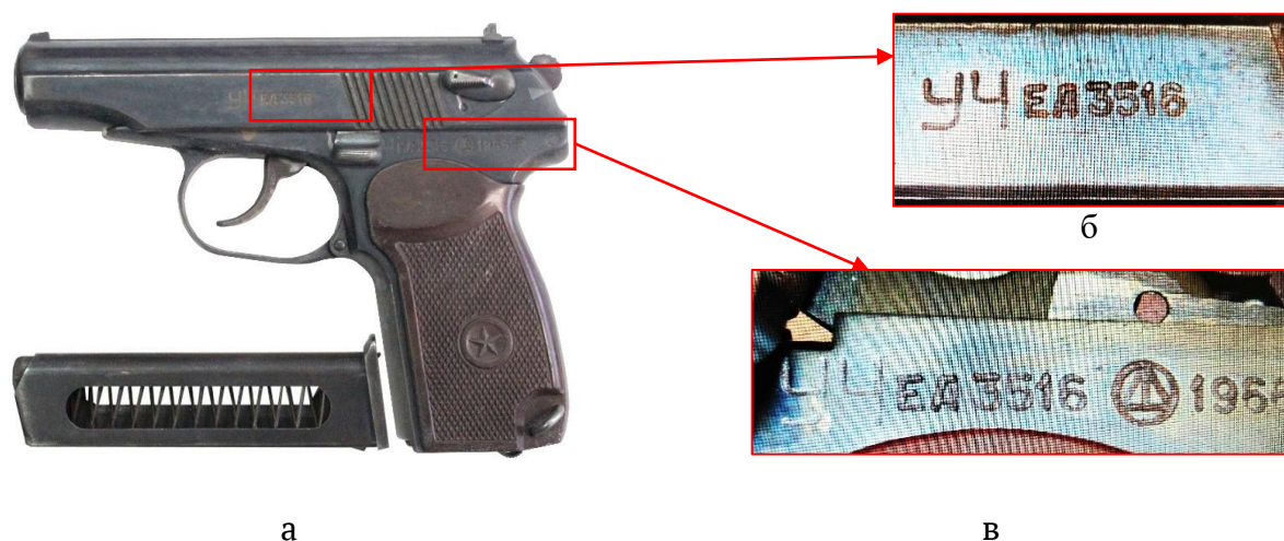
Рис. 1. Переделанный учебный ПМ в конструкцию которого внесены необратимые изменения: а – самодельным способом; б – маркировочные обозначения на левой части кожух-затвора; в – маркировочные обозначения на левой части pistolетной рамки
