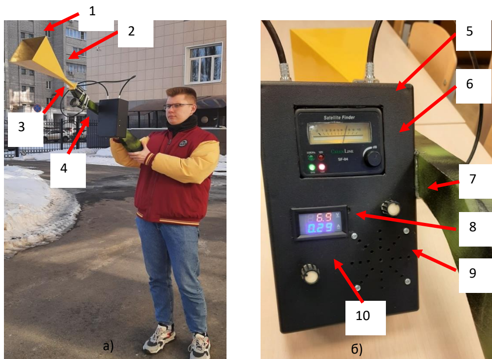
Рис. 5. Генератор СВЧ подсветки цели: а) рабочее положение генератора; б) вид панели контрольных приборов и регуляторов управления на обратной стороне. Здесь цифрами обозначены: 1 — рупорная излучающая антенна; 2 — генератор СВЧ на диоде
