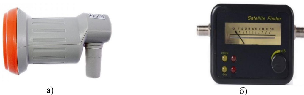
Рис. 3. Примененные в блоке подсветки приборы: а) конвертор Gi-211; б) прибор измерения уровня сигнала GSF9504
