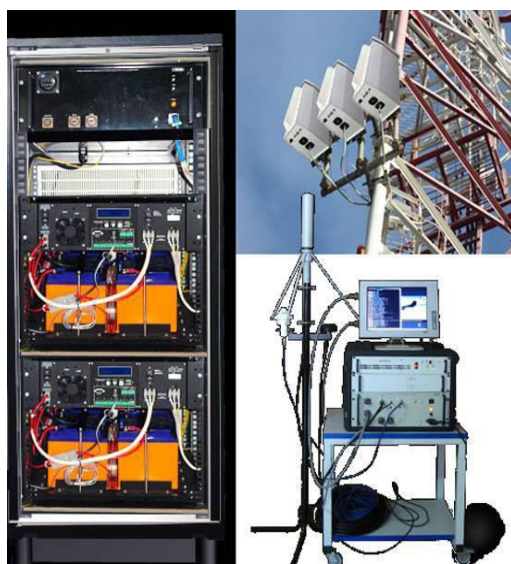
Рис. 3. Средства комплекса «Поле-21»: стойка с аппаратурой (слева), антенные модули (справа сверху) и пульт управления (справа внизу)
