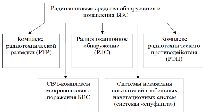
Рис. 1. Основные радиоволновые средства обнаружения и подавления БВС
