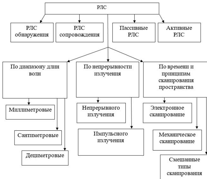
Рис. 2. Классификация РЛС с учетом взаимного влияния радиосредств
