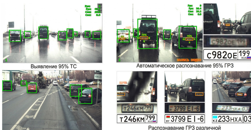
Рисунок 8 – Возможности АПК «АвтоУраган-МС» по распознаванию ТС и ГРЗ
