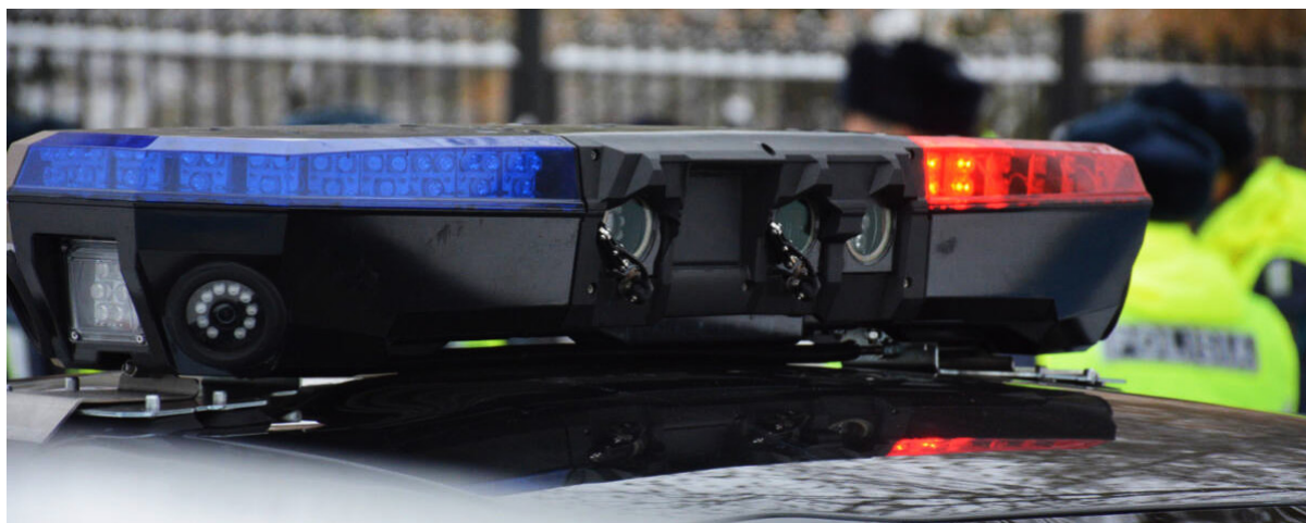
Рисунок 3 – Система очистки камер опытного образца АПК «Кибер-Шериф»
