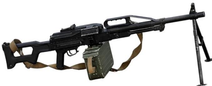
Рис. 21. 7,62-мм пулемёт Калашникова пехотный (ПКП)
