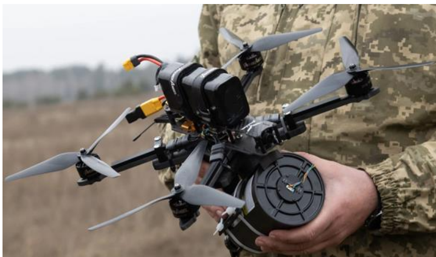
Рис. 14. FPV БВС с управлением на оптоволоконном кабеле
