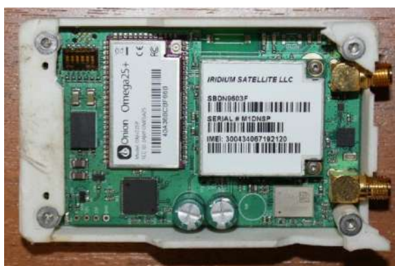
Рис. 12. Печатная плата БВС
