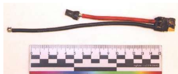
Рис. 13. Фрагмент электропроводки БВС
