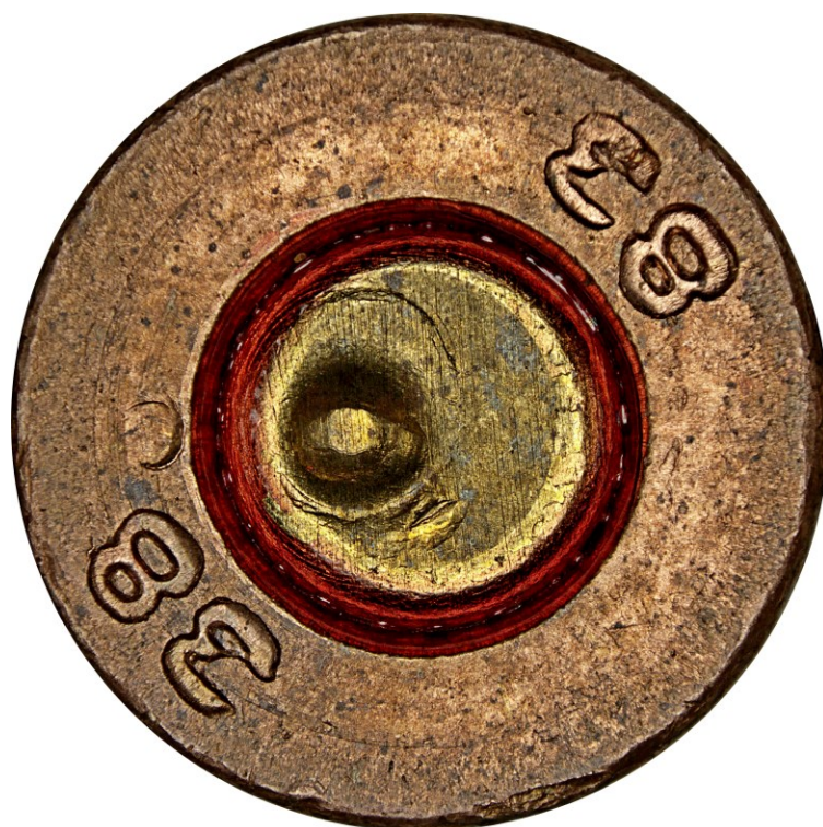
Рис. 73. След бойка на капсюле гильзы патрона 9х18 мм (ПМ), стреляной в самодельном пистолете
