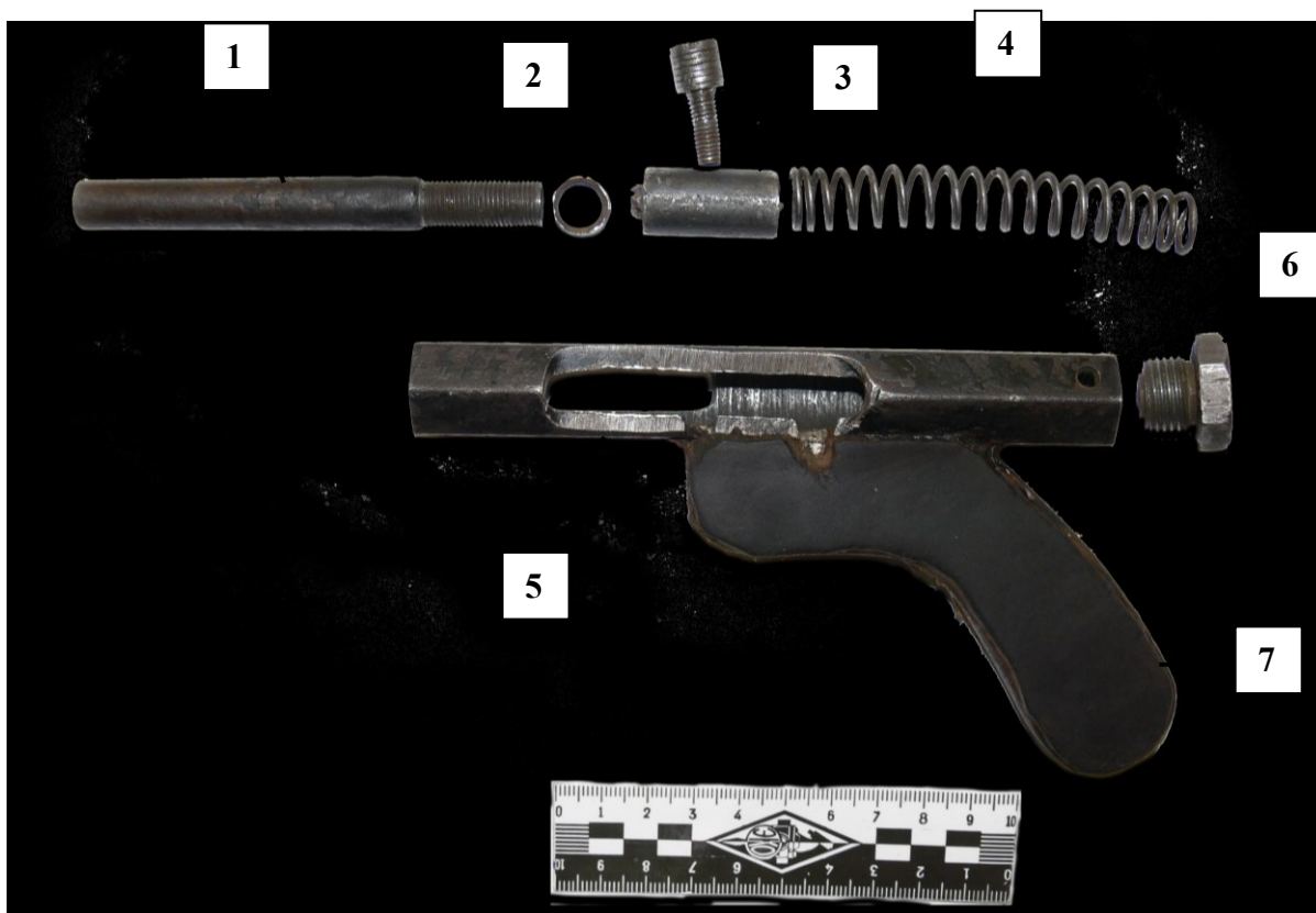
Рис. 7. Части и детали пистолета при его неполной разборке: 1 — ствол; 2 — рукоятка затвора; 3 — затвор; 4 — боевая пружина; 5 — ствольная коробка; 6 — заглушка ствольной коробки; 7 — основание с рукояткой
