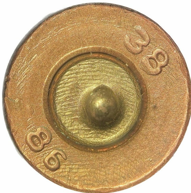
Рис. 65. Следы чашки затвора на капсюле гильзы, стреляной в 7,62 мм пистолете обр. 1930/33 гг. (ТТ)
