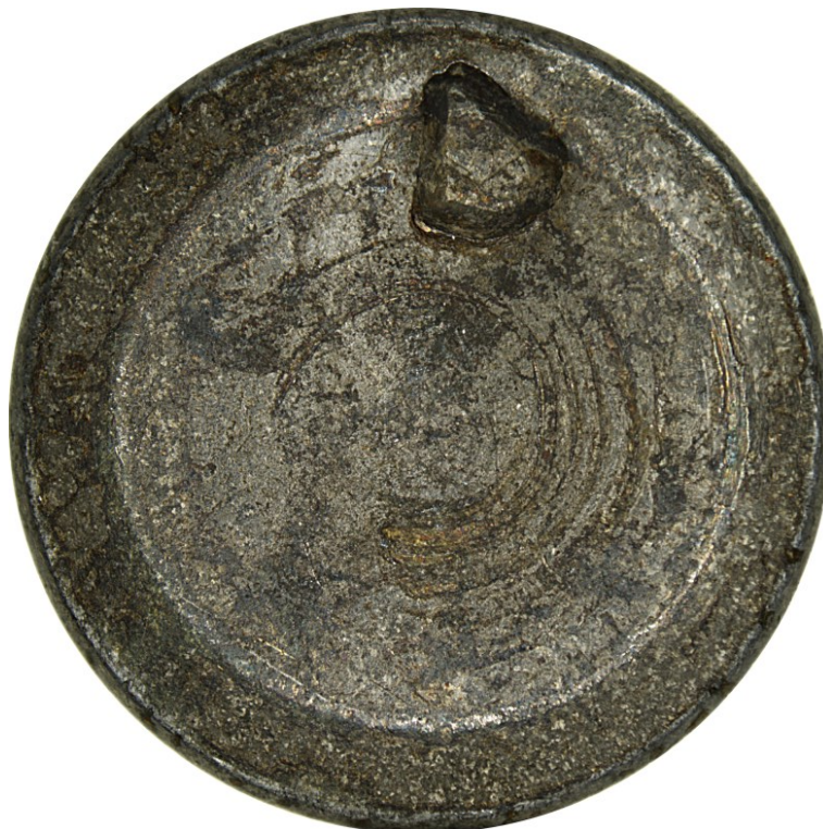
Рис. 75. След бойка ударника самодельного пистолета на торце донной части гильзы 5,6x16 мм патрона кольцевого воспламенения
