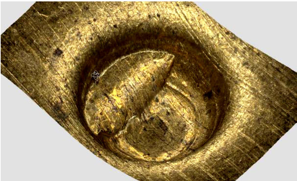
Рис. 113. 3D модель следа бойка на капсуле гильзы, стреляной в 9 мм пистолете ИЖ-71
