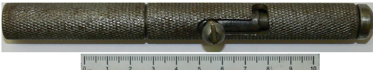
Рис. 8. Самодельный пистолет типа «стреляющая авторучка» под 5,6 мм патрон кольцевого воспламенения
