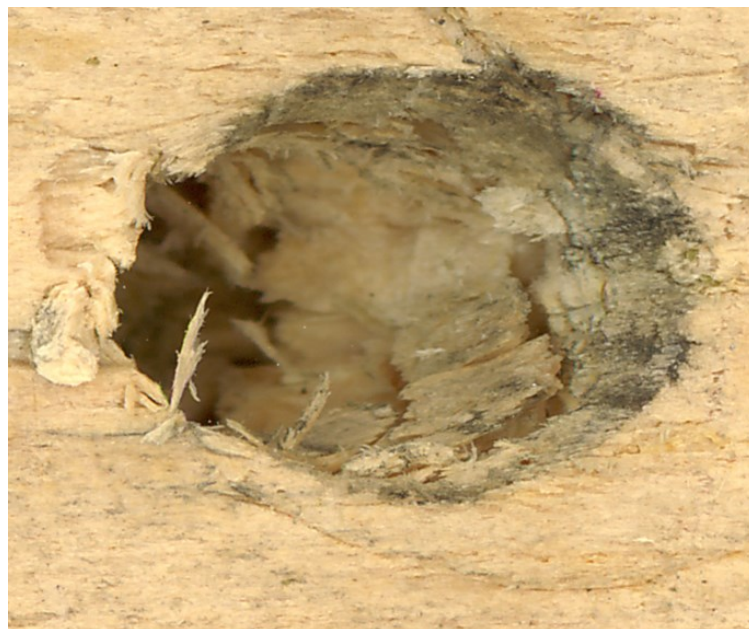
Рис. 94. Входное огнестрельное отверстие на древесине, образованное при стрельбе из 5,6 мм пистолета Марголина под углом к поверхности преграды: направление выстрела по стрелке
