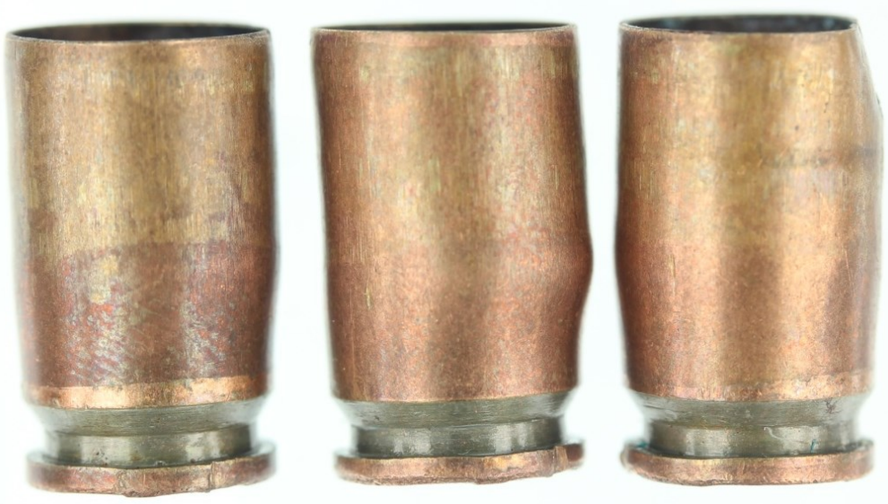
Рис. 72. Поддутия корпусов гильз, стреляных в самодельном пистолете под патрон 9х18 мм (ПМ)
