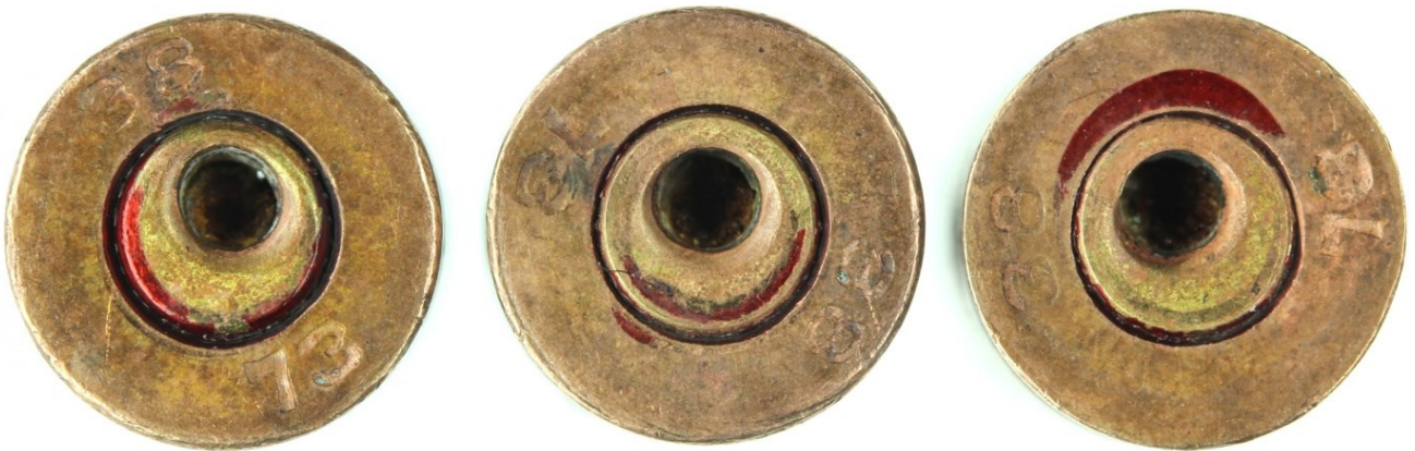
Рис. 77. Следы бойка ударника на капсюлях гильз 7,62х25 мм патронов, стреляных в самодельном пистолете
