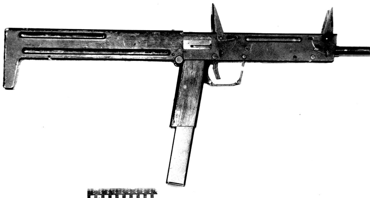
Рис. 45. 9-мм пистолет-пулемет ПП-90 не заводской сборки: ствол не обрезан по длине и выступает за пределы переднего среза корпуса
