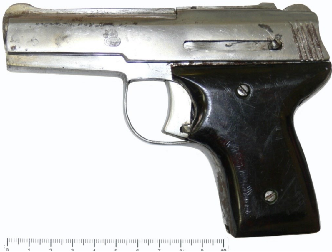
Рис. 11. Самодельный пистолет под 9x18 мм пистолетный патрон (ПМ)
