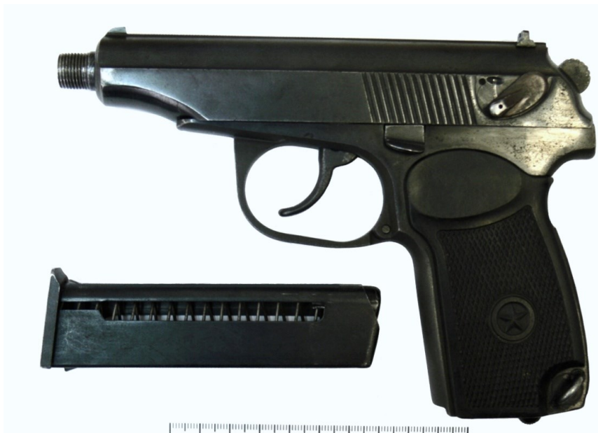
Рис. 36. Самодельный пистолет, переделанный из газового пистолета ИЖ-79 под патрон кал. 9x18 (ПМ), выступание дульной части ствола с внешней резьбой за пределы кожуха-затвора
