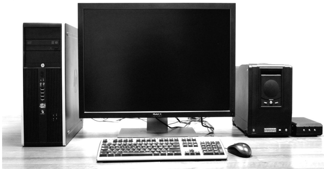
Рис. 100. Аппаратно-программный комплекс: баллистический сканер «POISC»
