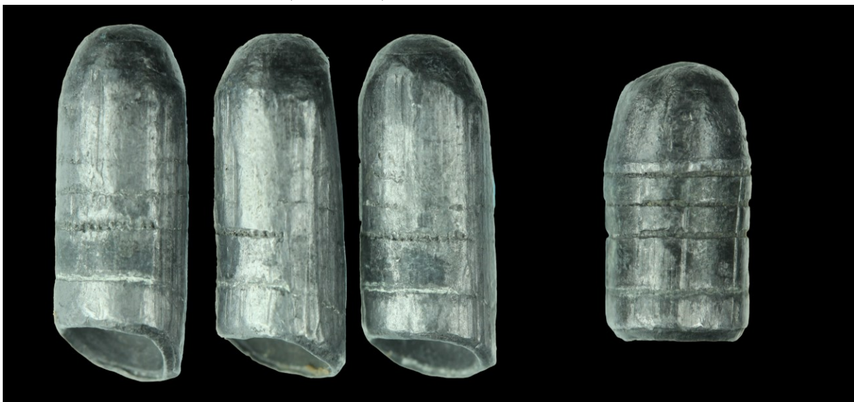
Рис. 54. Характерное вытягивание с боковым наклоном корпуса трех пуль, выстреленных из самодельного пистолета под 5,6 мм патрон кольцевого воспламенения (отдельно справа — пуля, выстреленная из 5,6 мм пистолета Марголина)
