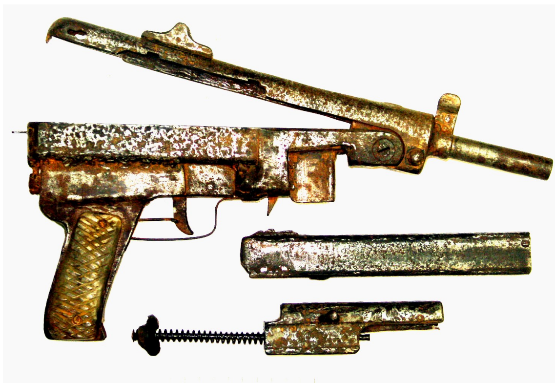
Рис. 31. Неполная разборка самодельного пистолета-пулемета
