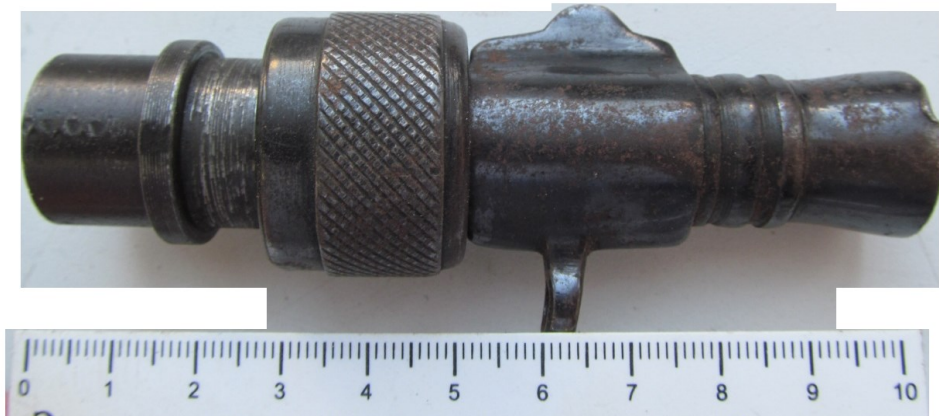
Рис. 20. Ствол и накидная (соединительная) муфта
