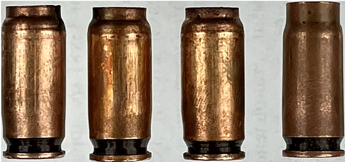
Рис. 70. Поддутия корпусов трех 7,62х25 мм гильз (слева), стреляных в самодельном пистолете, и стреляная в 7,62 мм пистолете обр. 1930/33 гг. (справа).
