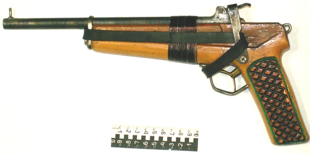
Рис. 5. Самодельный шомпольный пистолет «самопал»
