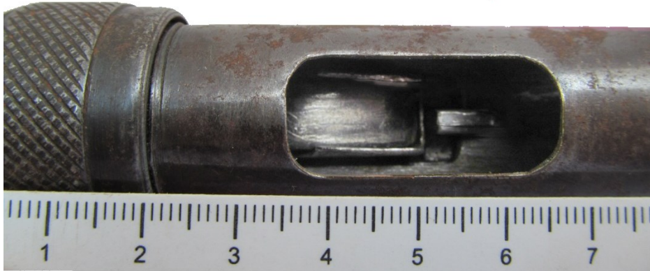
Рис. 25. Соединительная муфта на стволе и выводное окно
