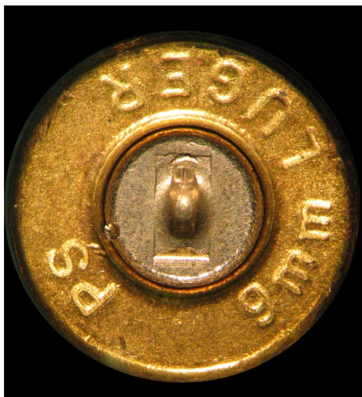
Рис. 67. Прямоугольный след от гнезда для бойка на гильзе, стреляной в 9 мм пистолете Глок-17
