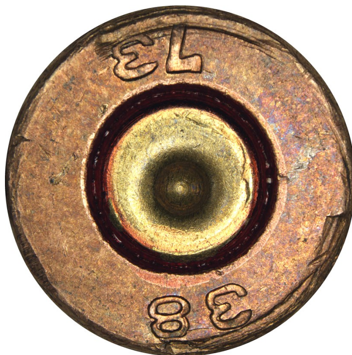
Рис. 79. Следы самодельной расточки чашки затвора на торце донной части гильзы патрона 9x18 мм (ПМ), стреляной в самодельном пистолете
