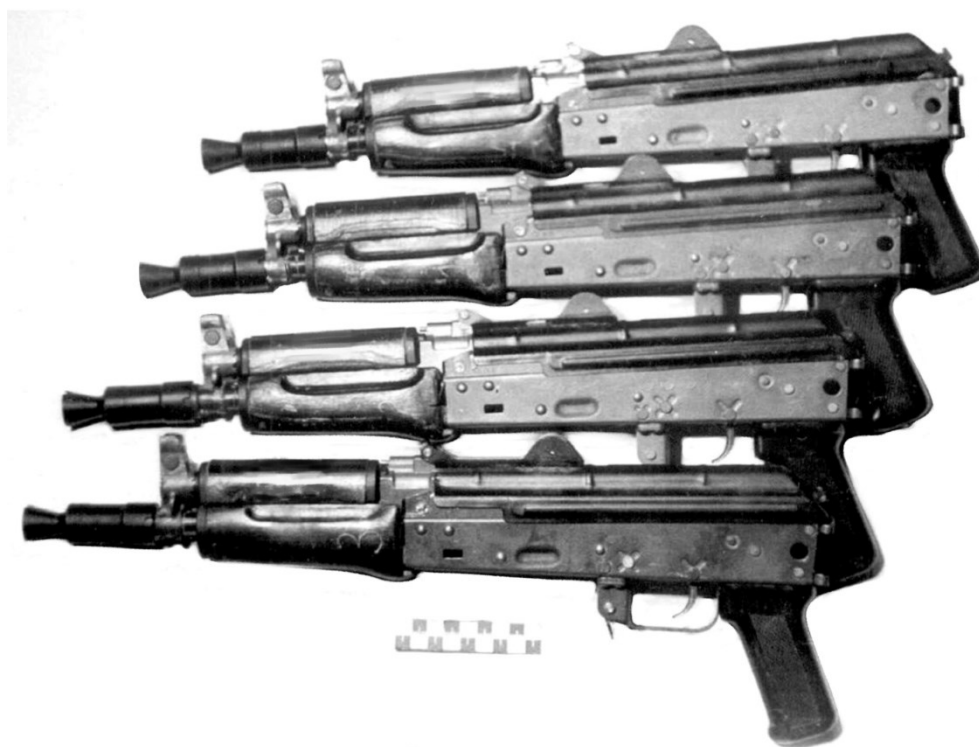
Рис. 43. 5,45-мм автоматы АКС-74У заводской сборки: отсутствуют приклад и элементы его крепления и фиксации
