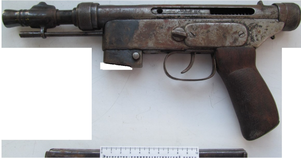
Рис. 18. Самодельный пистолет-пулемет под патрон 9x18 мм (ПМ) (вид слева)
