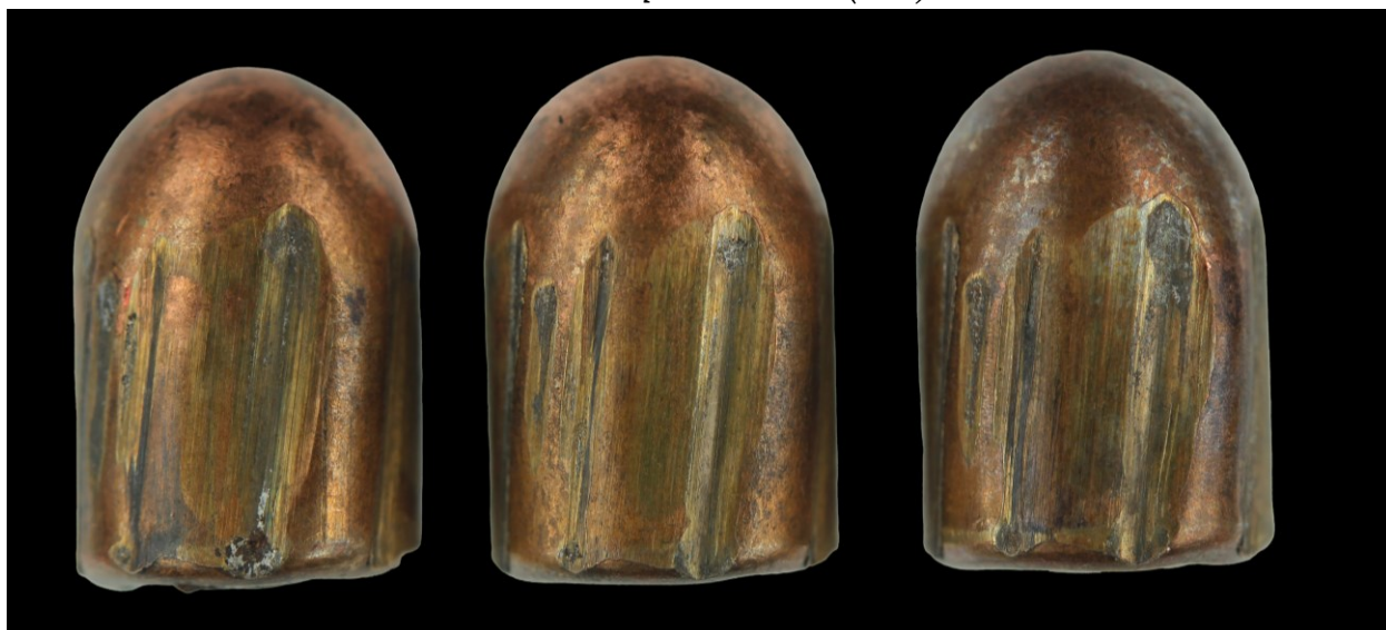
Рис. 52. Ведущая часть пули, выстреленной из самодельного пистолета под патрон 9x18 мм (ПМ)
