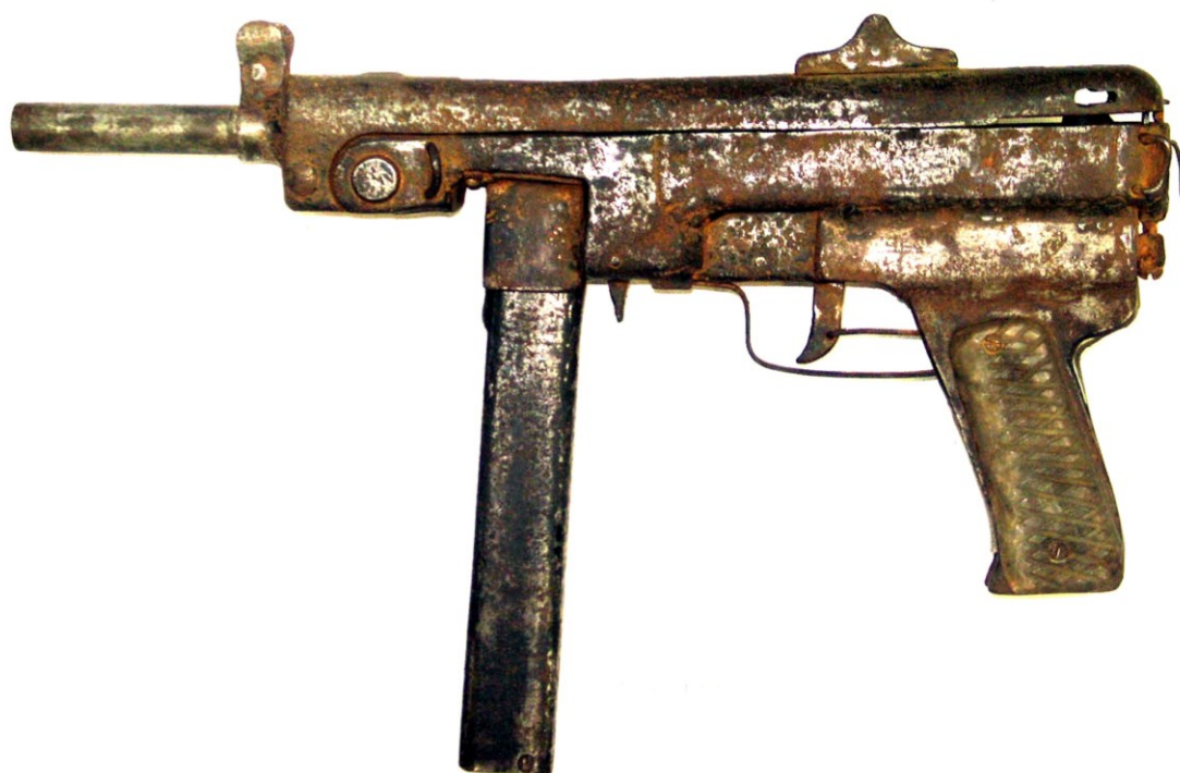
Рис. 30. Самодельный пистолет-пулемет, изготовленный с использованием частей и деталей 7,62 мм пистолета-пулемета ППШ-41
