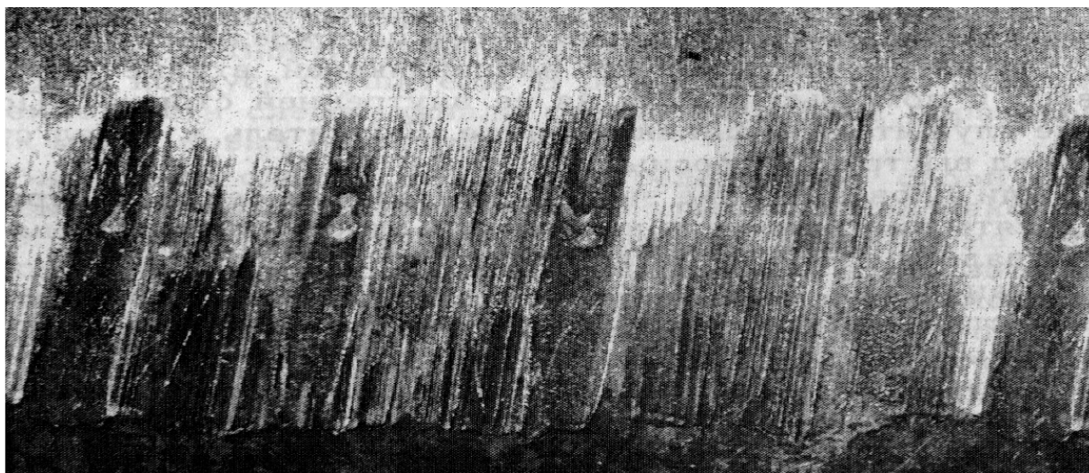
Рис. 59. Ведущая часть пули, выстреленной из 5,45 мм автомата Калашникова АКС-74У не заводской сборки с установленным самодельным глушителем: положение глушителя на стволе изменено
