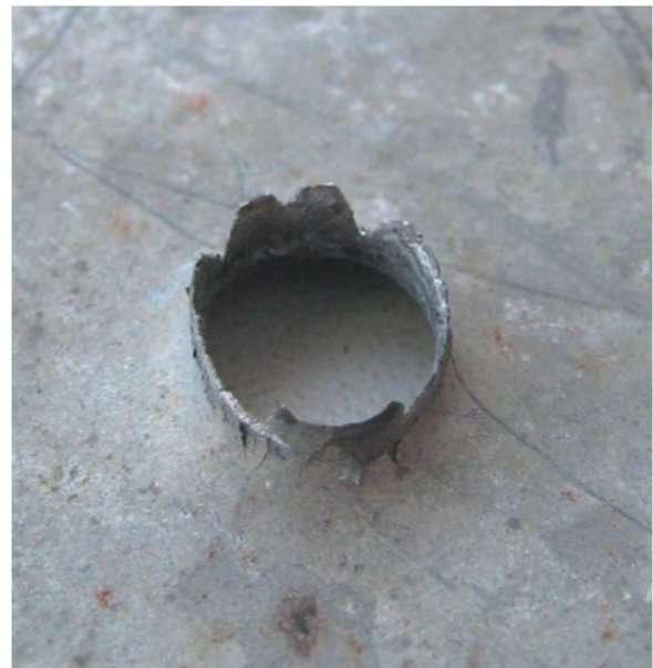
Рис. 92. Входное (А) и выходное (Б) огнестрельные отверстия на листе жести
