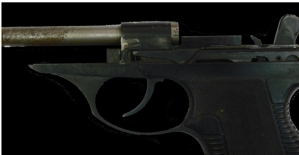
Рис. 37. Фрагмент конструкции пистолета, переделанного из газового пистолета модели ИЖ-78
