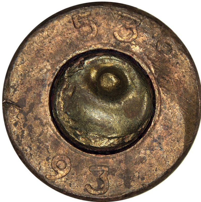
Рис. 74. След бойка на капсюле гильзы патрона 9x18 мм (ПМ), стреляной в самодельном пистолете
