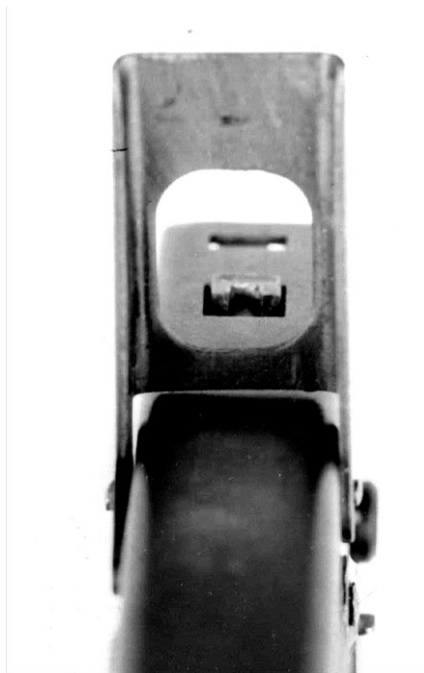
Рис. 46. Планка целика 9-мм пистолета-пулемета ПП-90 не заводской сборки: целик не прорезан
