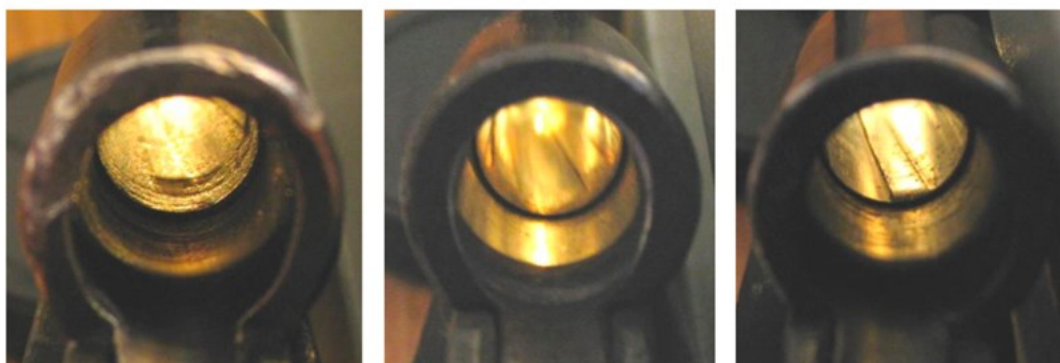
Рис. 122. Разновидности конструкции пульных входов перестроенных пистолетов: А — гладкий, Б — комбинированный, В — нарезной
