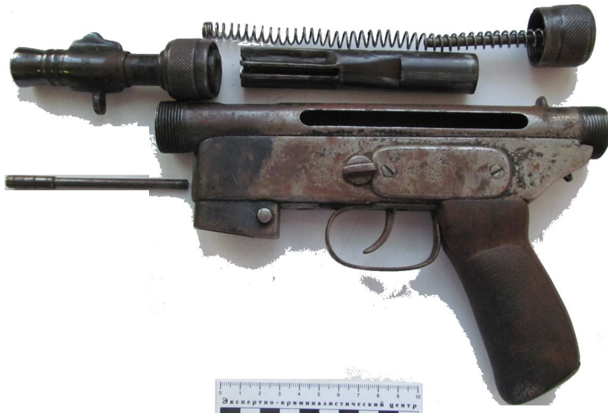
Рис. 19. Пистолет-пулемет в разобранном виде (неполная разборка)
