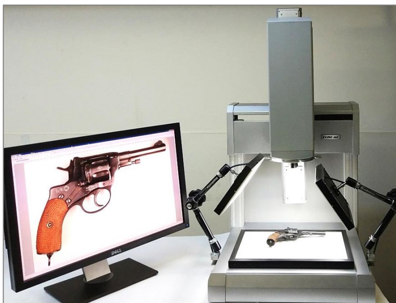
Рис. 98. Аппаратно-программный комплекс: микроскоп «POISC-МС»
