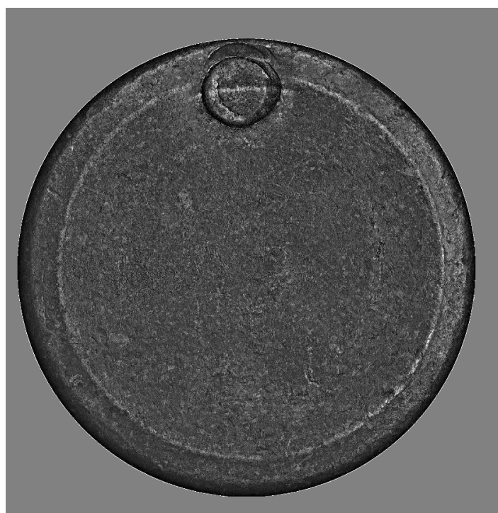
Рис. 61. След бойка ударника на капсюле гильзы, стреляной в 5,6 мм пистолете Марголина
