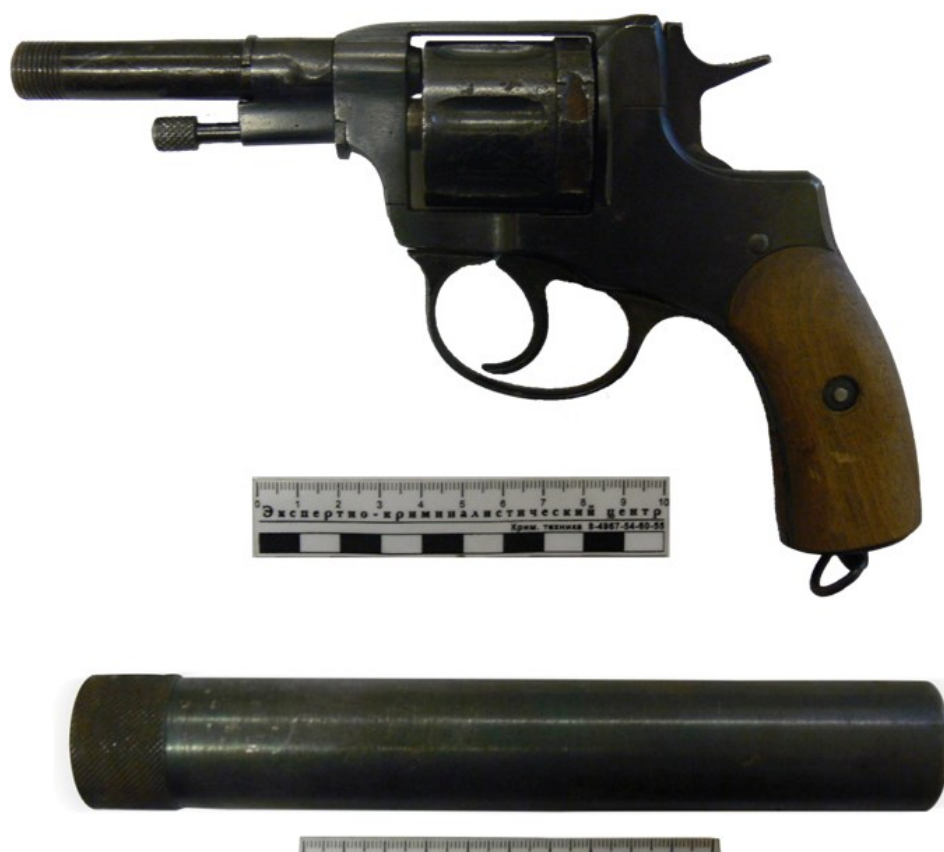
Рис. 97. 7,62 мм револьвер обр. 1895 г. (Наган) с самодельным глушителем к нему: на оружии самодельно удалена мушка и нарезана резьба для крепления глушителя
