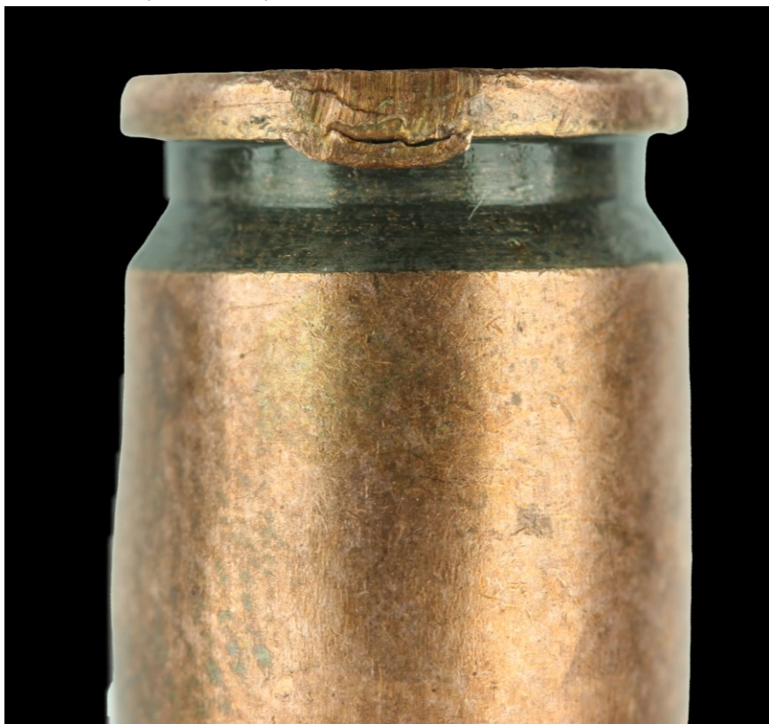
Рис. 80. След зацепа выбрасывателя на ребре торца донной части гильзы патрона 9x18 мм (ПМ), стреляной в самодельном пистолете
