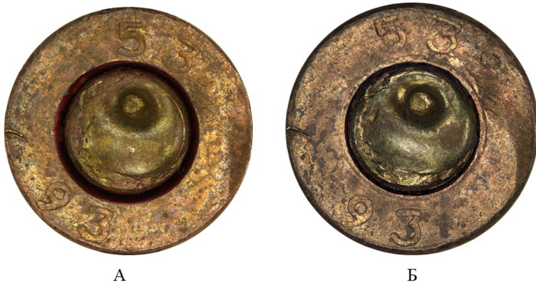
Рис. 84. Сопоставление следов самодельного пистолета под патрон 9x18 мм (ПМ) на торце донной части: А — исследуемой гильзы, Б — экспериментальной гильзы
