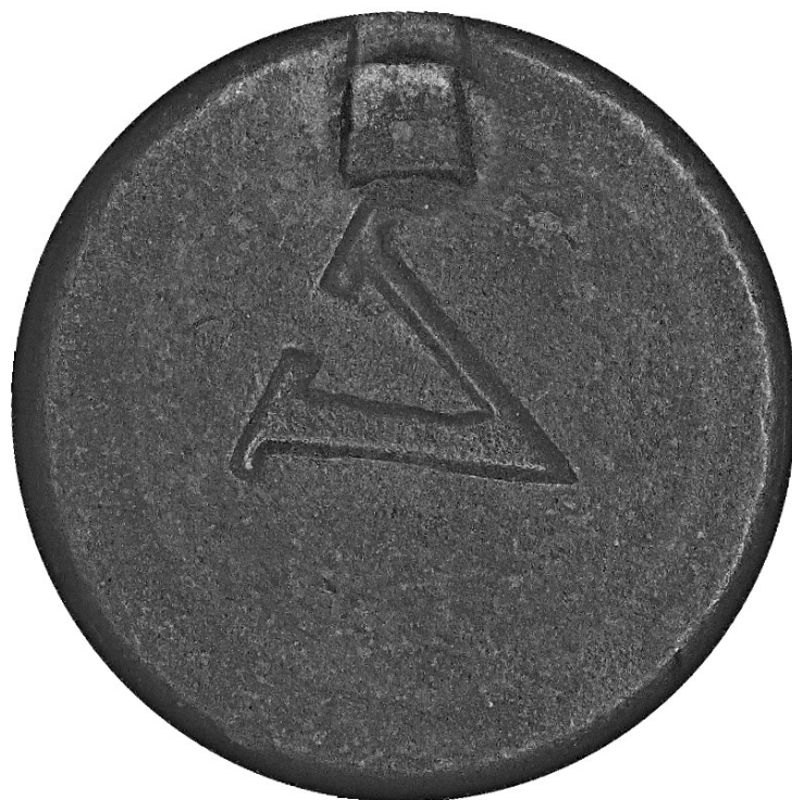
Рис. 62. След бойка ударника на капсюле гильзы, стреляной в 5,6 мм охотничьем карабине ТОЗ-16
