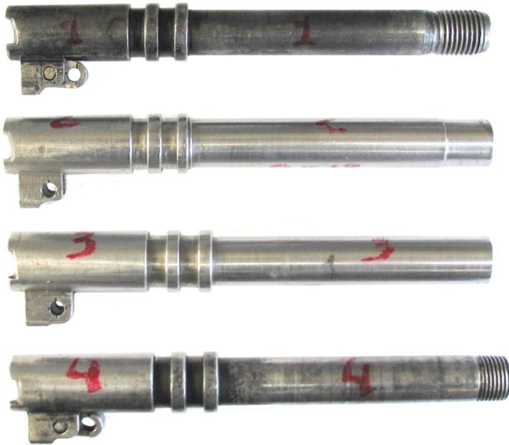
Рис. 81. Самодельные сменные стволы под патрон 9x18 мм (ПМ) к 7,62 мм пистолету обр. 1930/33 гг. (ТТ)
