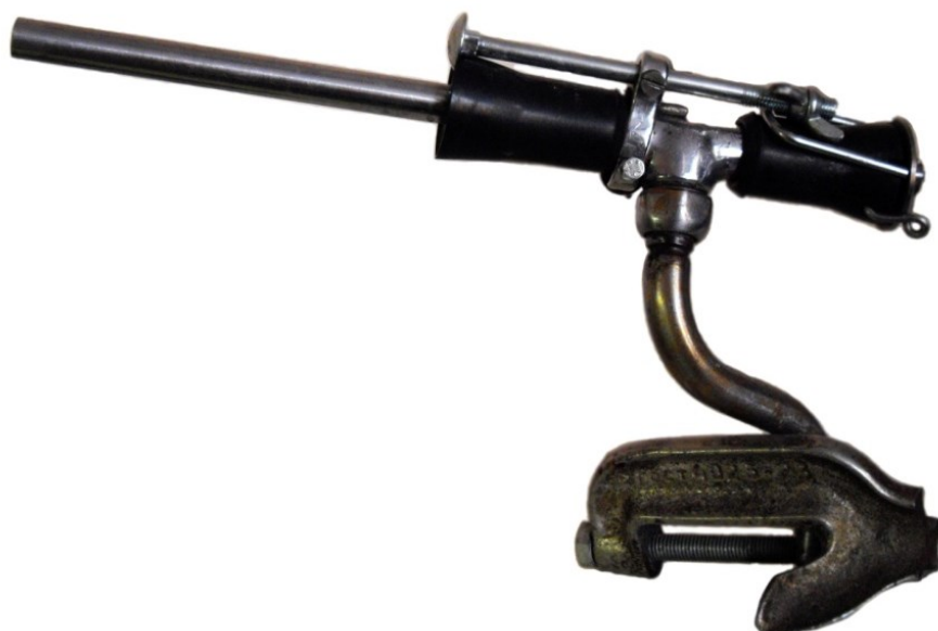
Рис. 27. Самодельное стреляющее устройство, в конструкции которого использованы элементы предметов хозяйственно-бытового назначения (мясорубка, костыль, смеситель для душа)
