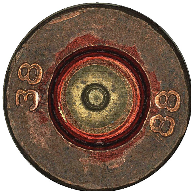
Рис. 60. След бойка ударника на капсюле гильзы, стреляной в 7,62 мм снайперской винтовке Драгунова (СВД)
