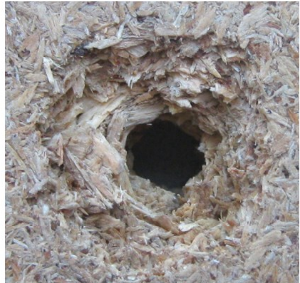
Рис. 91. Входное (А) и выходное (Б) огнестрельные отверстия на листе ДСП
