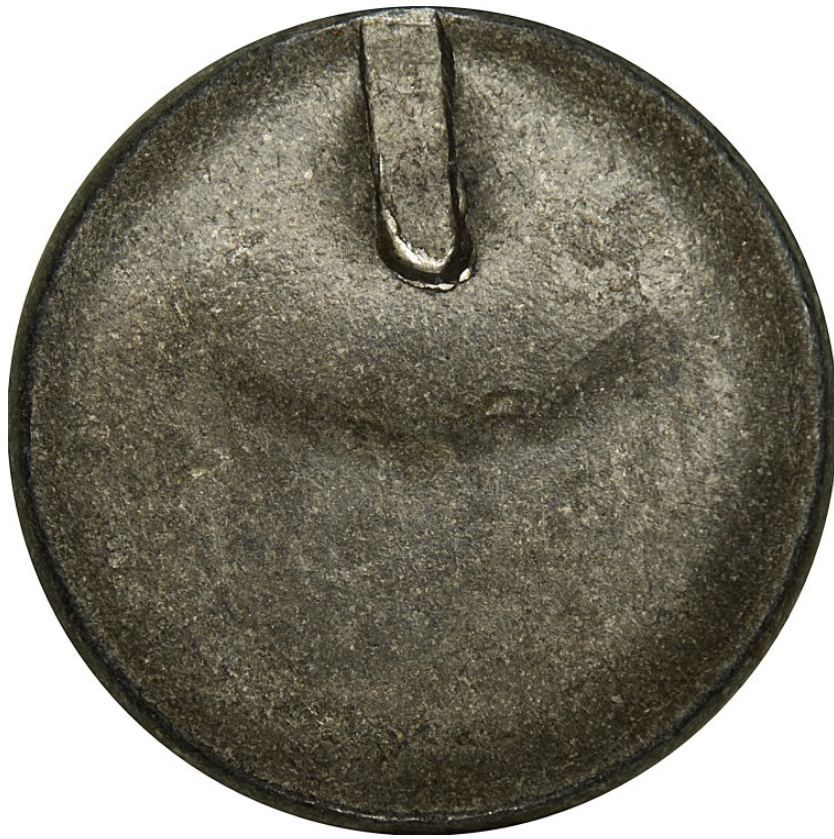
Рис. 76. След бойка ударника самодельного пистолета на торце донной части гильзы 5,6х16 мм патрона кольцевого воспламенения
