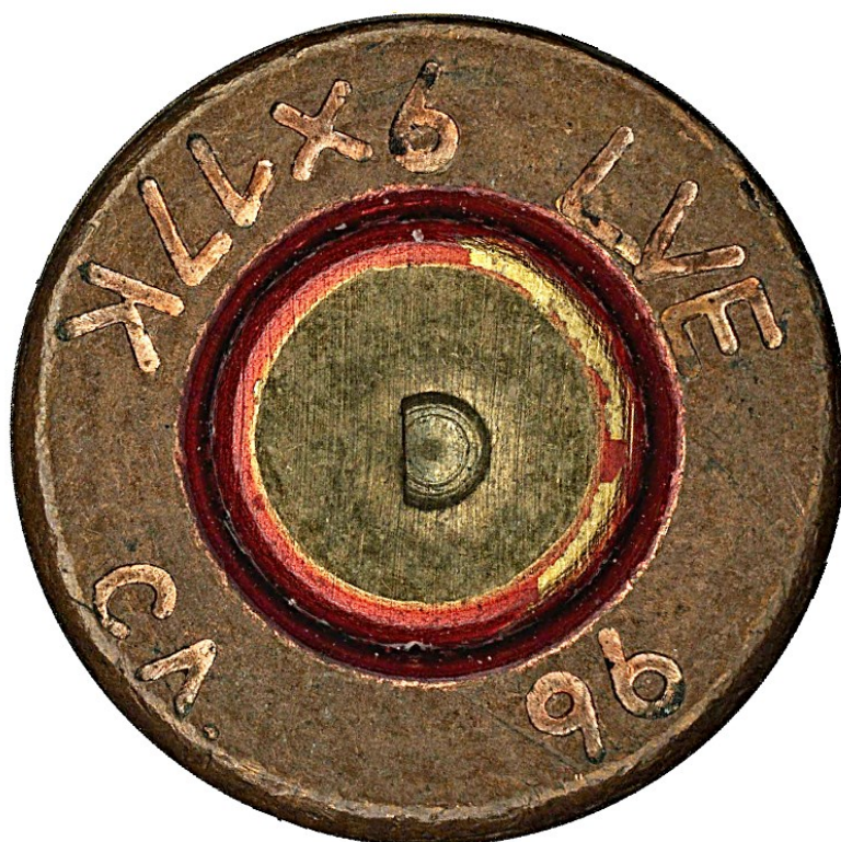
Рис. 63. След бойка ударника на капсюле гильзы, стреляной в 9 мм пистолете ИЖ-71
