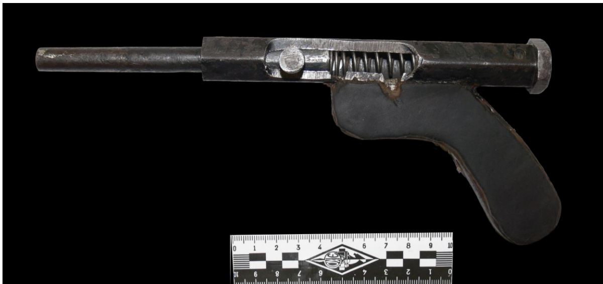
Рис. 6. Самодельный однозарядный пистолет под патрон кольцевого воспламенения кал. 5,6 мм
