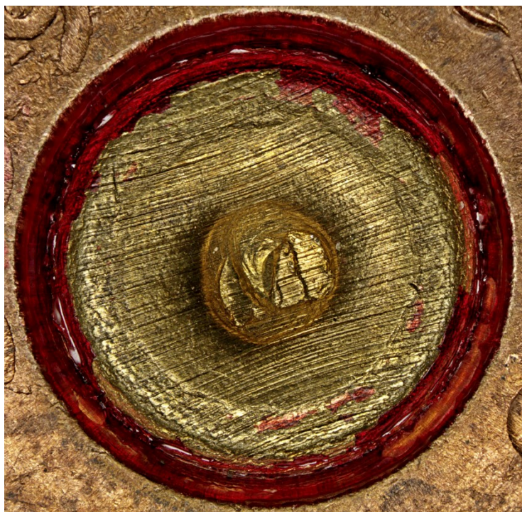
Рис. 78. След боя ударника на капсюле гильзы 9x18 мм (ПМ) патрона, стреляной в самодельном пистолете
