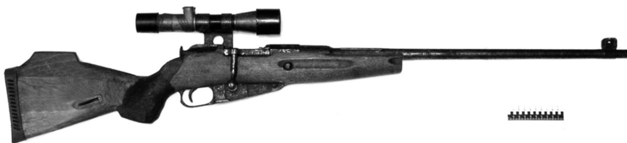
Рис. 35. Карабин, самодельно переделанный из 7,62 мм винтовки Мосина обр. 1891/30 гг.
