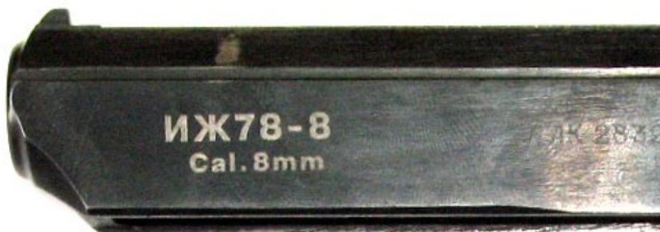
Рис. 38. Заводские маркировочные обозначения на кожухе-затворе переделанного в огнестрельное оружие из газового пистолета
