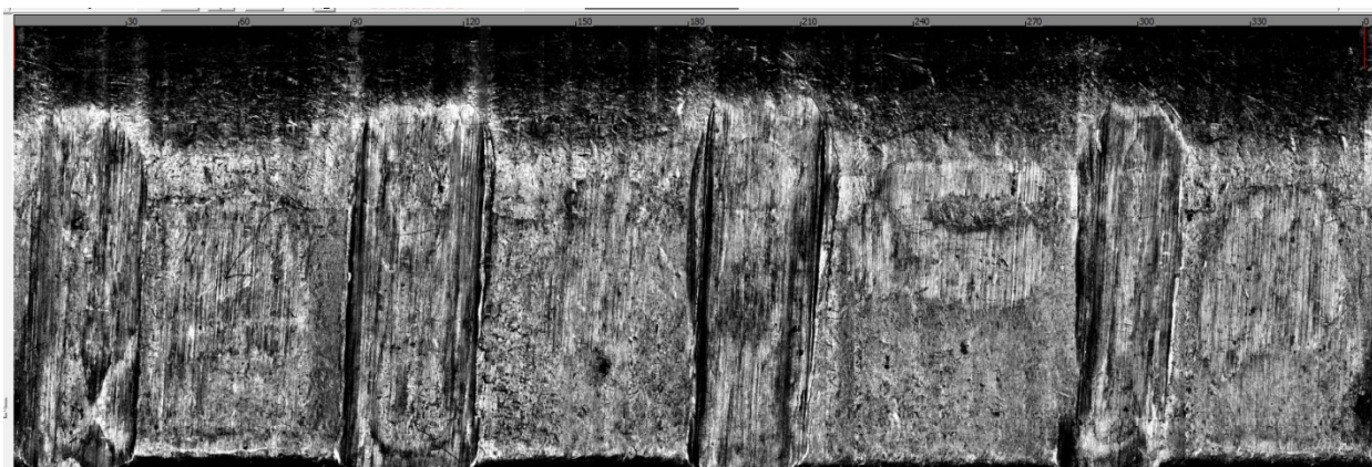
Рис. 52. Ведущая часть пули, выстреленной из самодельного пистолета под патрон 9x18 мм (ПМ)
