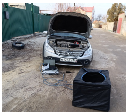
Рис. 4. Подключение 3D-сканера к транспортному средству при помощи автоинвертора Dexr CAR 1500 W
