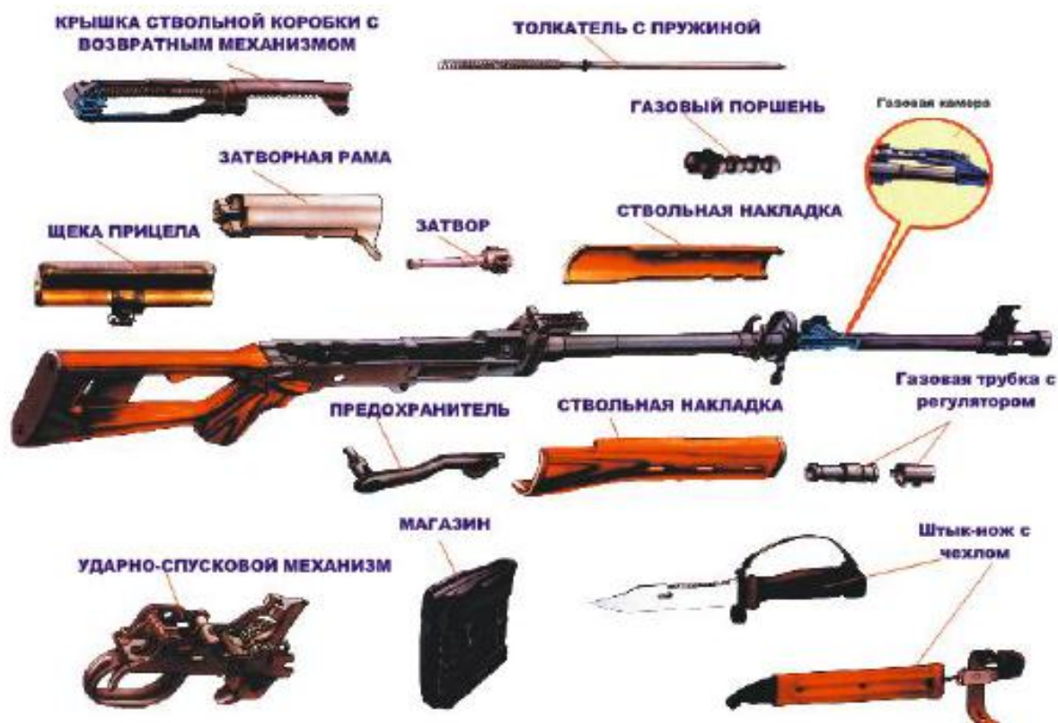
Рис. 11. Общее устройство СВД
