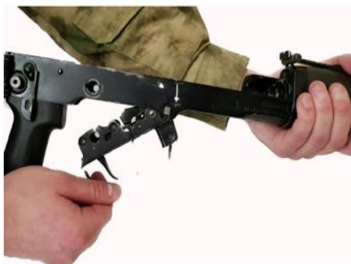
Рис. 18. Отделение ударно-спускового механизма: а — отделение предохранителя; б — отделение ударно-спускового механизма
