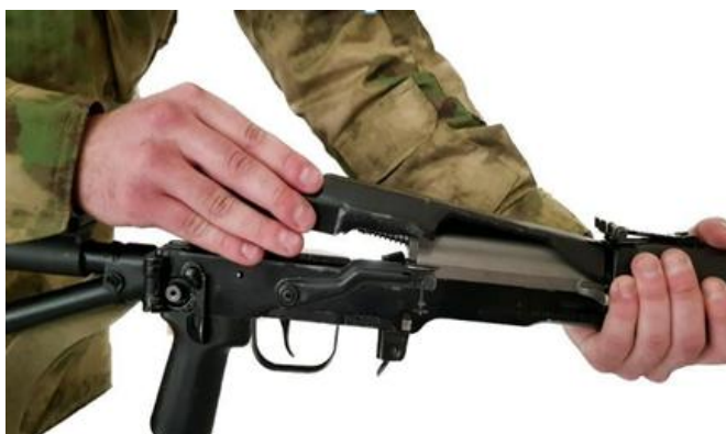
Рис. 15. Отделение крышки ствольной коробки с возвратным механизмом
