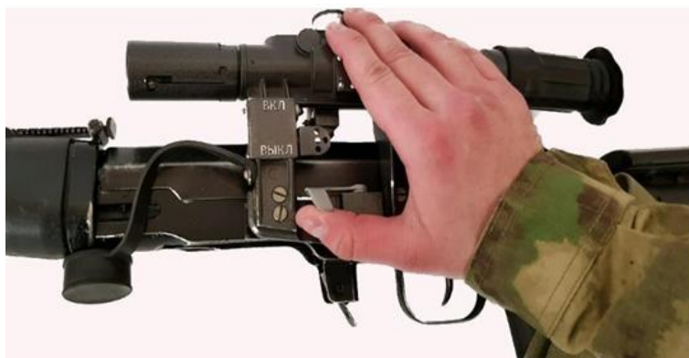
Рис. 13. Отделение оптического прицела
