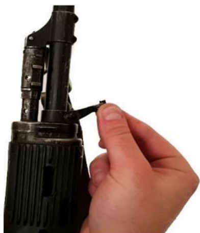
Рис. 19. Отделение ствольных накладок: а — поворот замыкателя; б — отделение ствольной накладки
