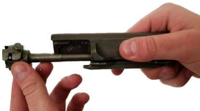
Рис. 17. Отделение затвора от затворной рамы
