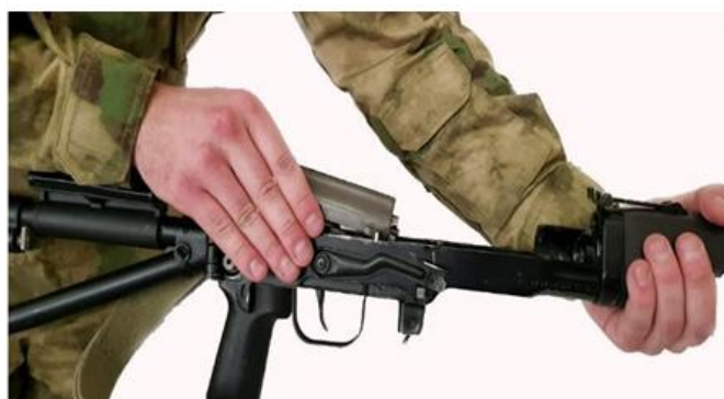
Рис. 16. Отделение крышки ствольной коробки с возвратным механизмом
