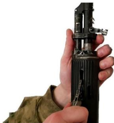
Рис. 19. Отделение ствольных накладок: а — поворот замыкателя; б — отделение ствольной накладки
