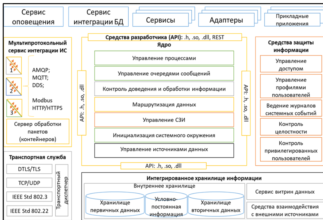
Рис. 3.8. Структурно-функциональная схема интеграционной шины – ядра цифровой платформы БАС [258]
