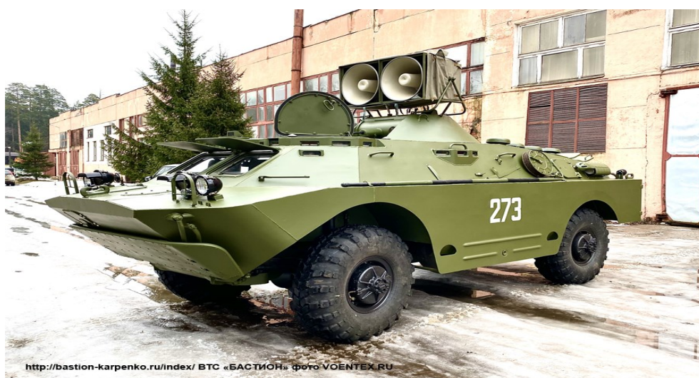
Рисунок 3. Акустическая система ЗС-96.2 на базе БТР-80
