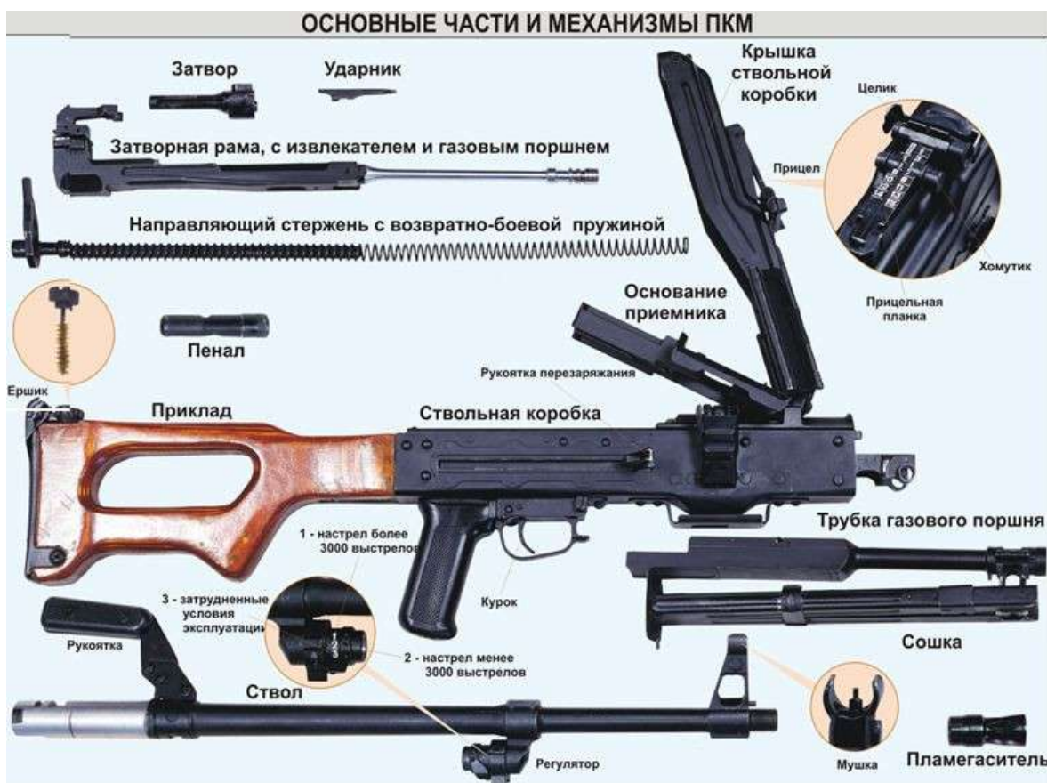
Рисунок 4. Основные части и механизмы ПКМ
