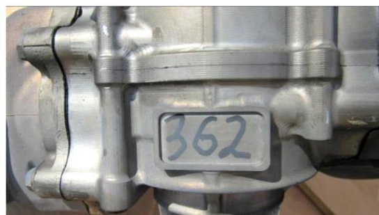
Фото 14–15. Рукописные записи на деталях беспилотного воздушного судна
