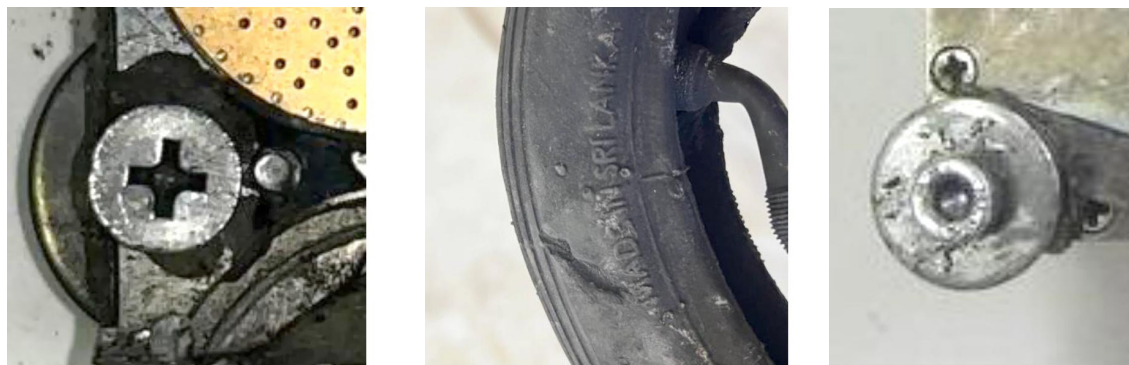
Фото 9–11. Элементы кустарно собранного дрона, содержащие следы производственных механизмов
