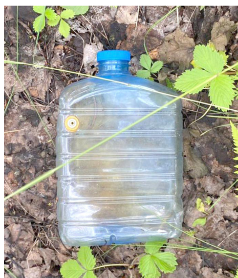
Фото 4. Полимерная емкость, используемая в качестве топливного бака
