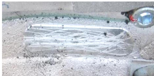
Фото 13. Маркировочная площадка с удаленным идентификационным номером двигателя
