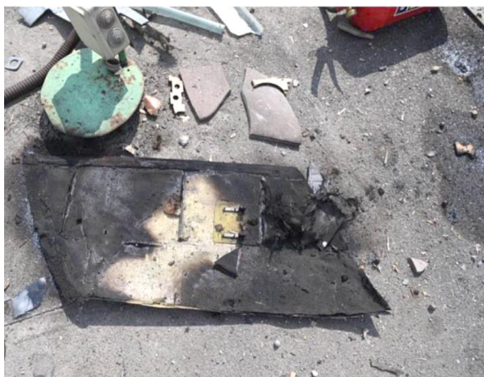
Фото 7. Фрагмент фюзеляжа дрона, подвергшегося термическому воздействию
