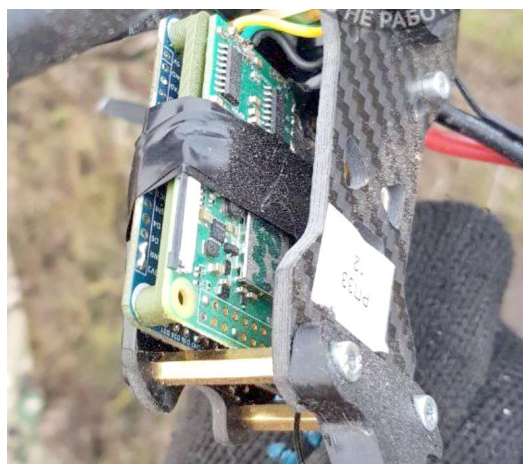
Фото 6. Полетный контроллер дрона с SIM-картой сотового оператора
