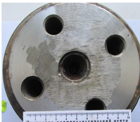
Рис. 4. Удаление маркировочных обозначений на торцевой поверхности шейки оси колесной пары при помощи углошлифовальной машинки
