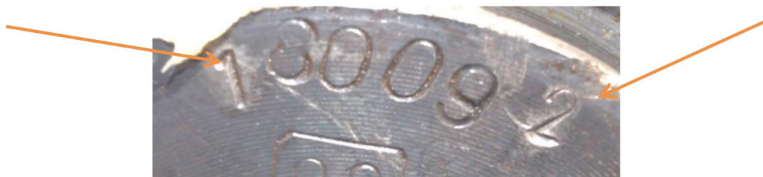
Рис. 1. Добавление (добитие) цифр «1» и «2» в идентификационный номер колесной пары
