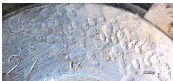
Рис. 3. Забитие при помощи ударного инструмента части маркировочной площадки на торцевой поверхности шейки оси колесной пары
