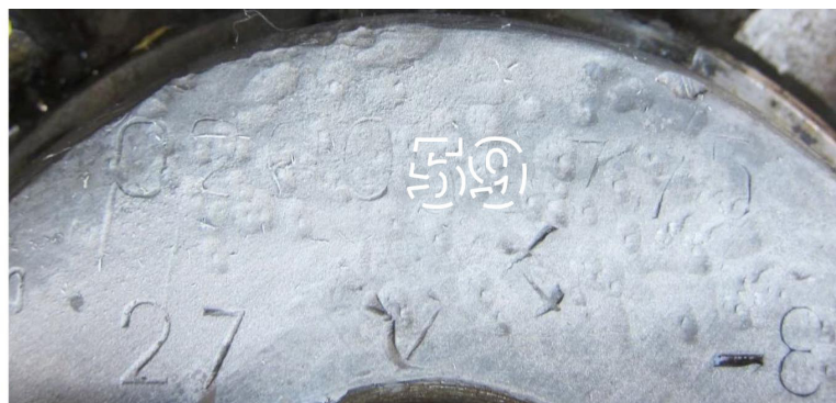
Рис. 10. Исследуемая маркировочная площадка представленной на экспертизу шейки оси колесной пары с выявленными знаками маркировочного обозначения
