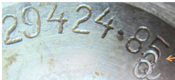
Рис. 2. Нанесение цифры поверх другой (цифры «6» на цифру «5») в идентификационном номере (год выпуска) колесной пары
