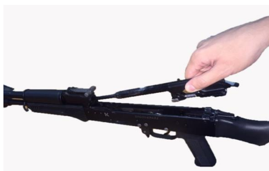
Рис. 68. Отделение затворной рамы
