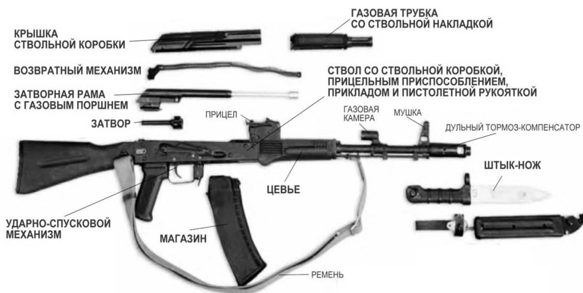
Рис. 42. Основные части и механизмы автомата АКС74
