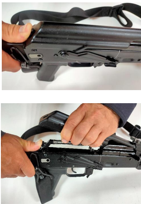
Рис. 66. Отделение крышки ствольной коробки
