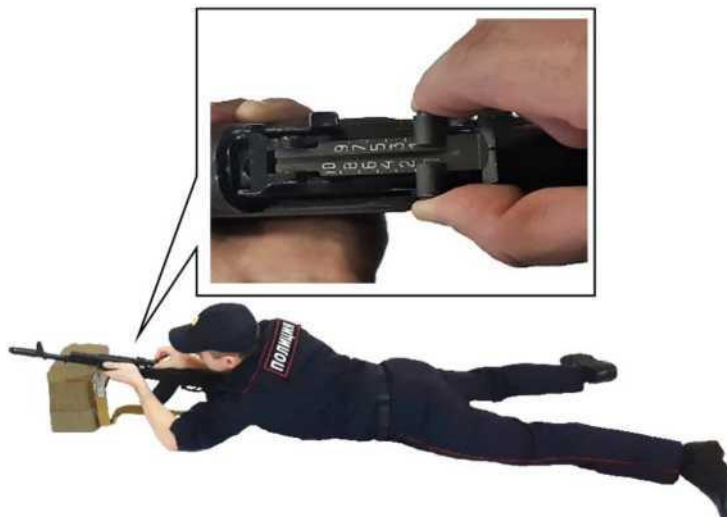
Рис. 75. Установка прицела при выборе дальности стрельбы 200 м
