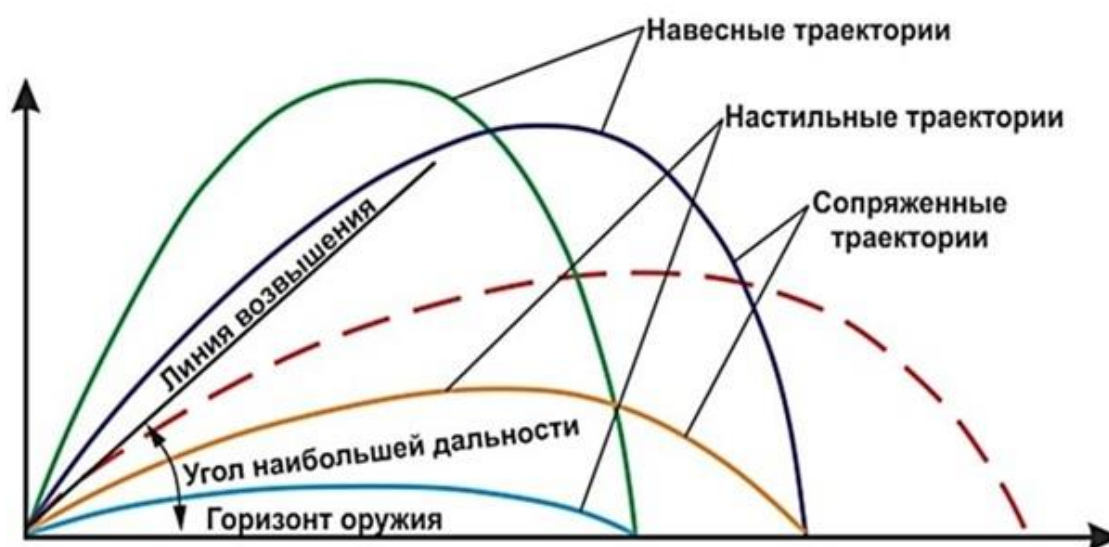
Рис. 31. Угол наибольшей дальности; настильные, навесные и сопряженные траектории
