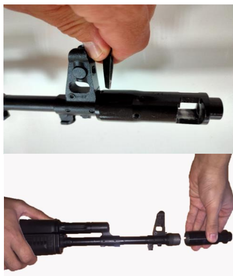
Рис. 65. Отделение дульного тормоза-компенсатора
