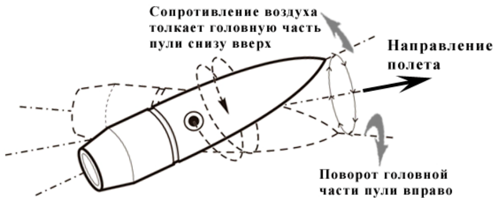
Рис. 26. В результате двух вращательных движений пуля постепенно поворачивает головную часть вправо (в сторону вращения)
