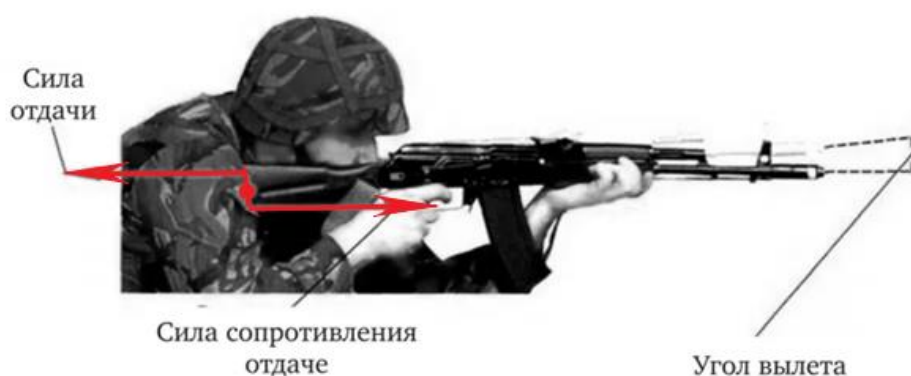
Рис. 17. Пары сил, отклоняющие ствол автомата вверх и влево
