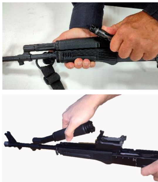
Рис. 70. Отделение газовой трубки со ствольной накладкой
