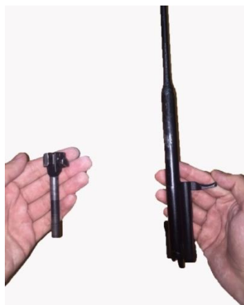
Рис. 69. Отделение затвора от затворной рамы
