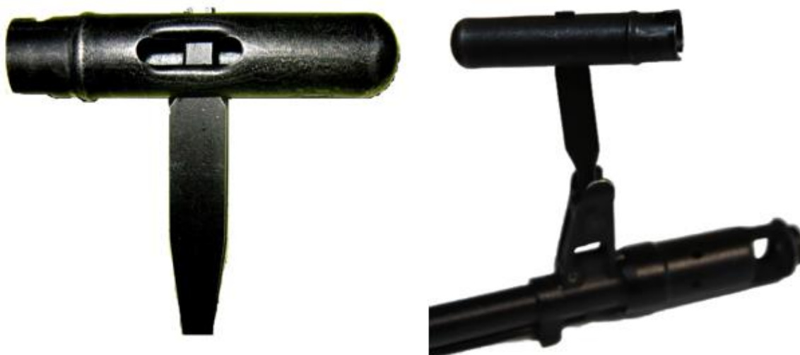
Рисунок 2.43. Регулировка по вертикали (с помощью отвертки и пенала).
