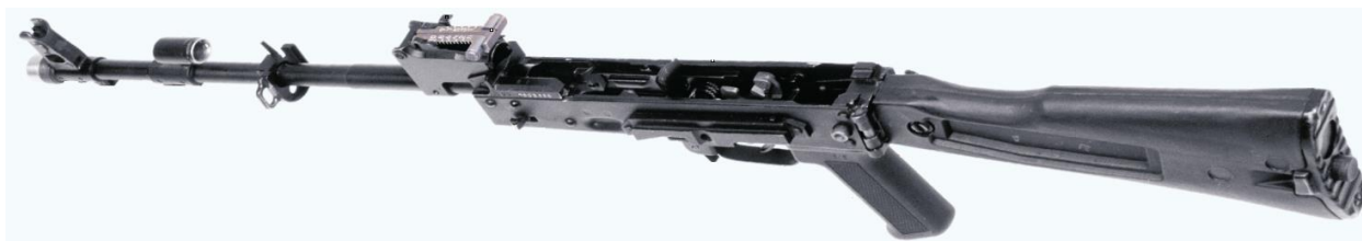
Рисунок 2.29. Ствол со ствольной коробкой (и крышкой ствольной коробки у укороченного автомата), с ударно-спусковым механизмом, размещенным в ствольной коробке, прицельным приспособлением, постоянным или складывающимся прикладом и пистолетной рукояткой.
