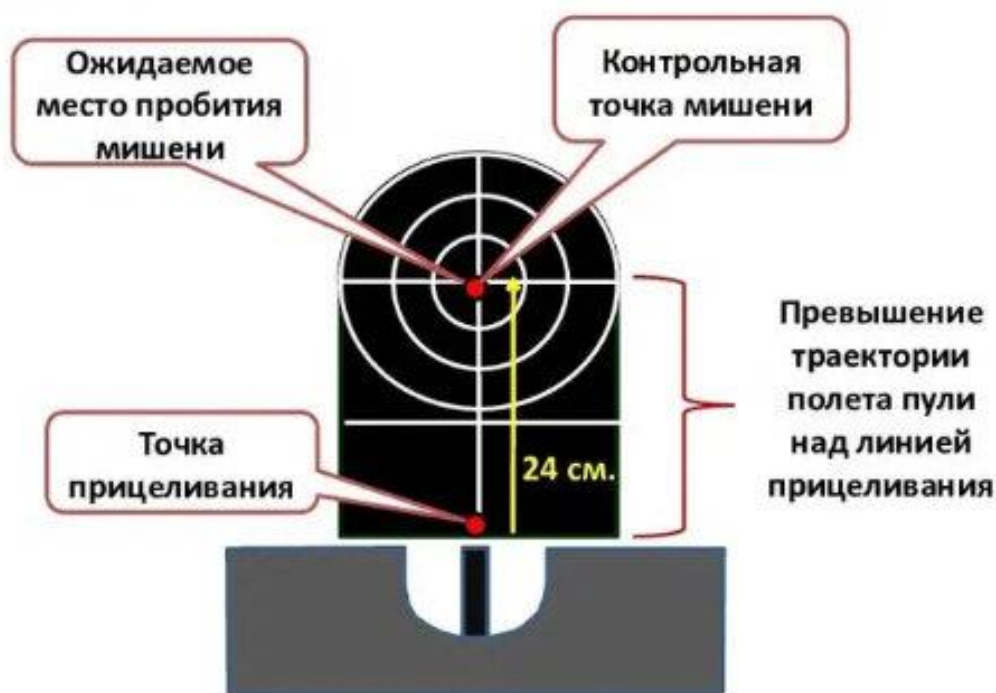
Рисунок 2.38. Порядок прицеливания при проверке боя АКМ.
