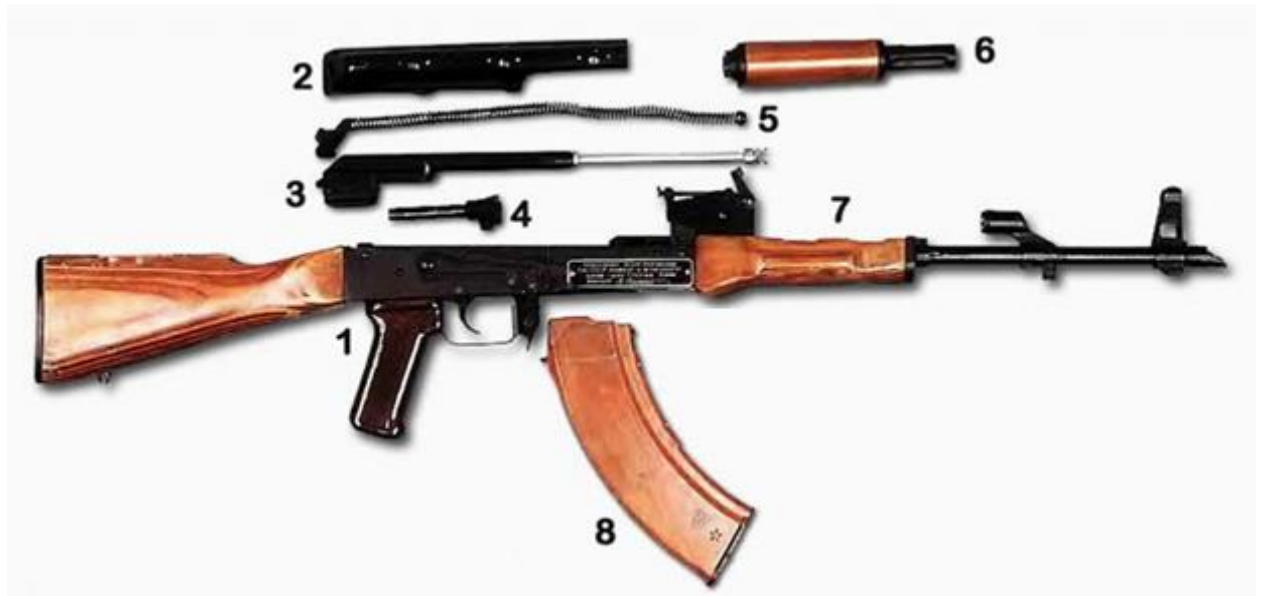
Рисунок 2.23. Основные части и механизмы автомата Калашникова.
