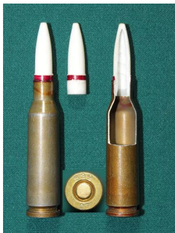
Рисунок 2.22. 5,45-мм холостой патрон.
