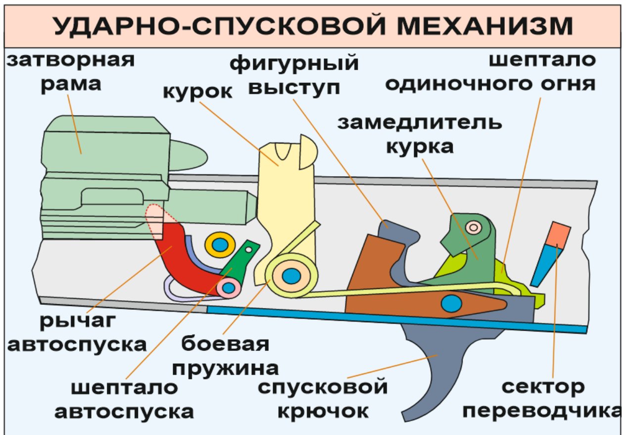
Рисунок 2.36. Блок-схема ударно-спускового механизма автомата Калашникова.
