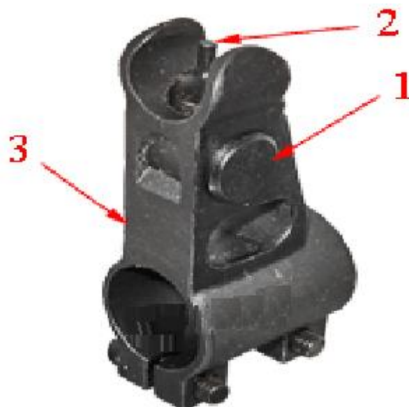
Рисунок 2.41. Основание мушки: 1 – полосок мушки, 2 – мушка, 3 – основание мушки.
