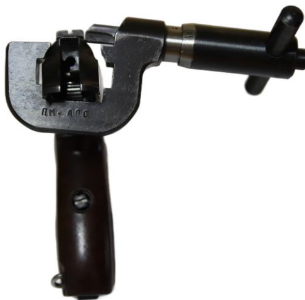
Рисунок 4.18. Регулировка боя пистолета ПМ (АПС) с помощью ПРБ.
