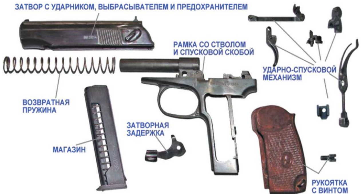
Рисунок 4.9. Части и механизмы пистолета Макарова.
