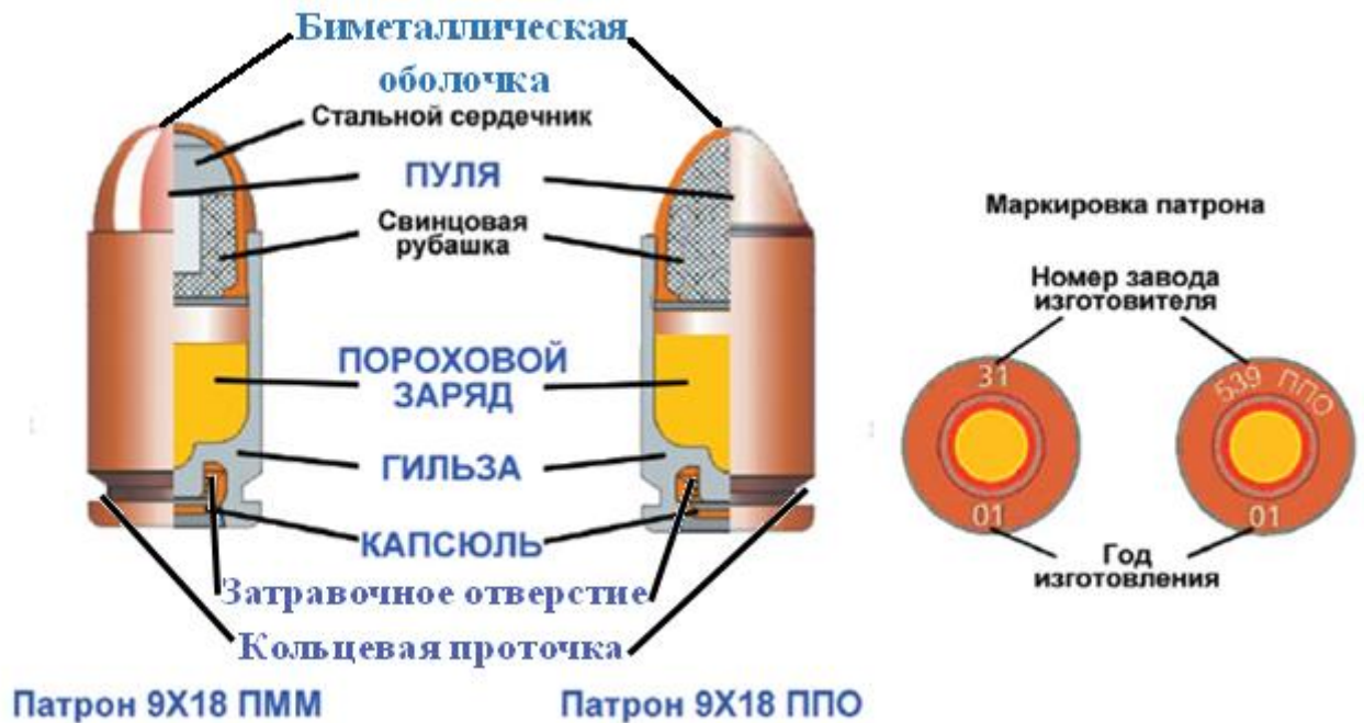
Рисунок 4.8. Устройство патрона пистолета Макарова.
