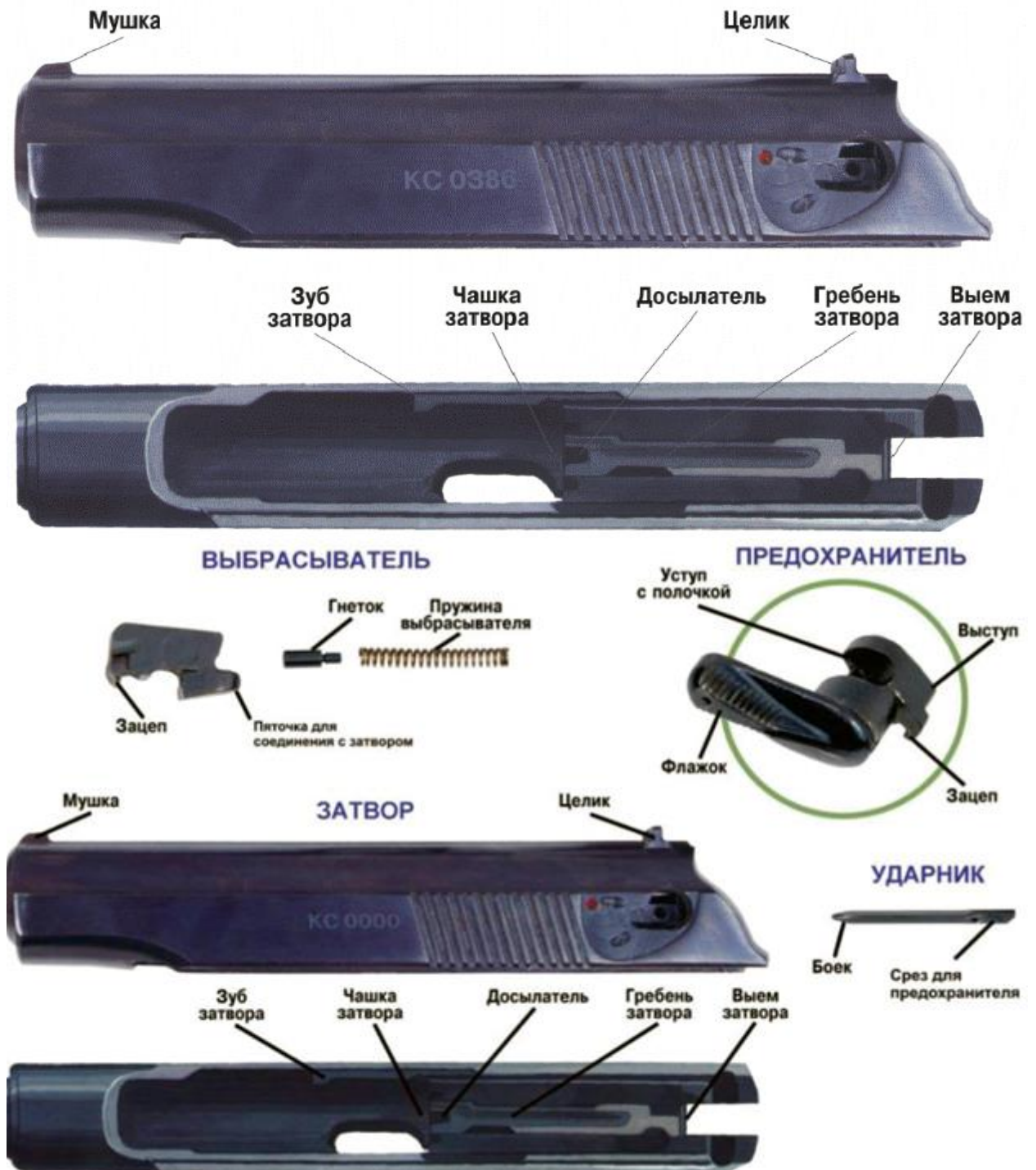
Рисунок 4.11. Затвор с ударником, выбрасывателем и предохранителем.
