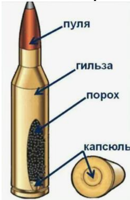
Рисунок 2.5. Основные части патрона автомата Калашникова.
