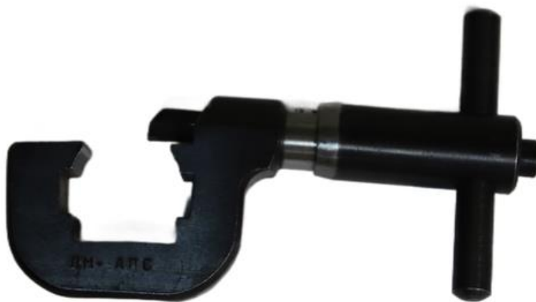
Рисунок 4.18. Прибор регулировки боя для ПМ (АПС).
