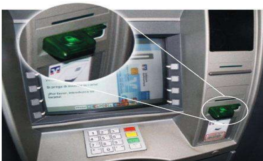
Рис. 2. Один из видов устройства скимминга
