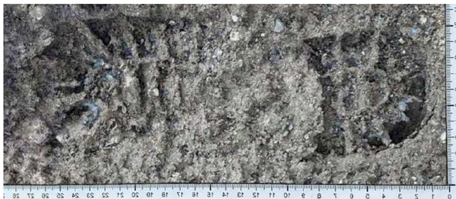
Рис. 9. След подошвенной части обуви на влажном суглинке спустя 6 дней после образования.
