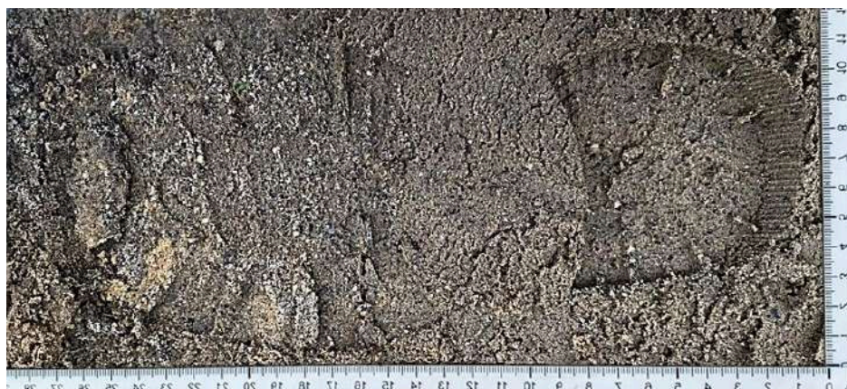
Рис. 10. След подошвенной части обуви на влажной супеси сразу после его образования.
