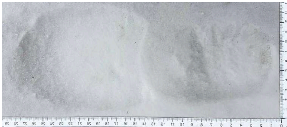
Рис. 5. След подошвенной части обуви на рассыпчатом снегу спустя 2 минуты после его образования.
