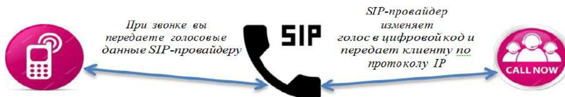
Рис. 13. Схема звонка по SIP-телефонии
