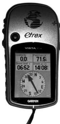
Рис. 30. Навигация к заранее выбранной точке на GPS-навигаторе
