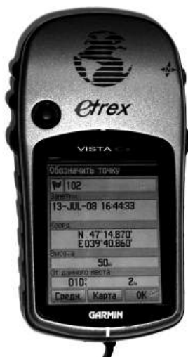
Рис. 29. Привязка точки наблюдения на GPS-навигаторе
