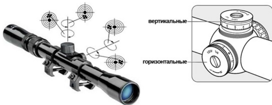
Рис. 20. Механизм ввода вертикальных и горизонтальных поправок
