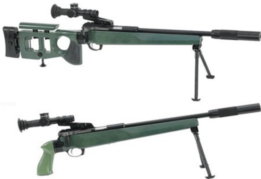
Рис. 13. 5,6-мм снайперская винтовка СВ-99
