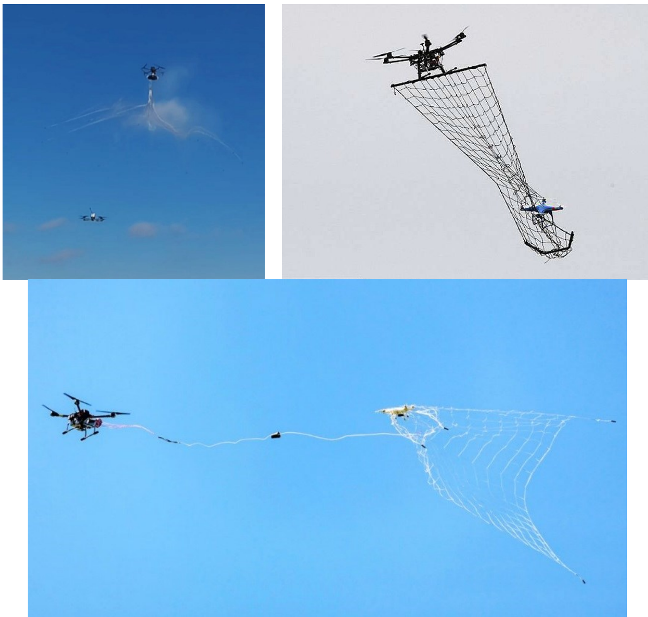
Рисунок 34. Использование сетей для борьбы с БВС
