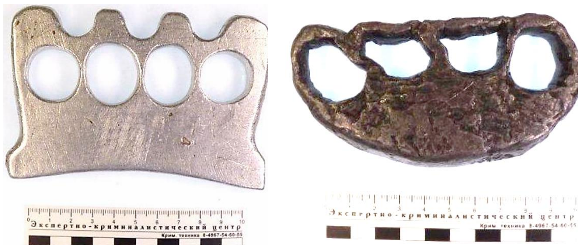
Рис. 7.34. Объекты судебной экспертизы холодного оружия: кастет (слева) и предмет по типу кастета (справа): явно видна деформация ударной части
