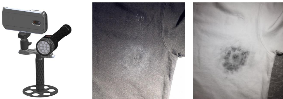
Рис. 7.29. Возможности комплекса экспертного света «3116.01 БЕЛЫЙ/ИК» по выявлению следов выстрела на темной одежде: общий вид комплекса (слева); вид темной футболки с повреждением в белом свете (в центре); вид той же футболки в ИК свете (справа): отчетливо видны следы воздействия пороховых газов
