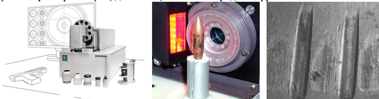
Рис. 5.3. Сканер поверхностей БС-16 (слева), сканирование поверхности пули при боковом освещении (в центре), полученный фрагмент развертки поверхности пули (справа)
