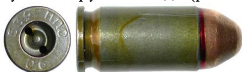
Рис. 7.11. Вид доньшка патрона без капсюля с запальными отверстиями (слева) и общий вид патрона ППО калибра 9 мм (справа)
