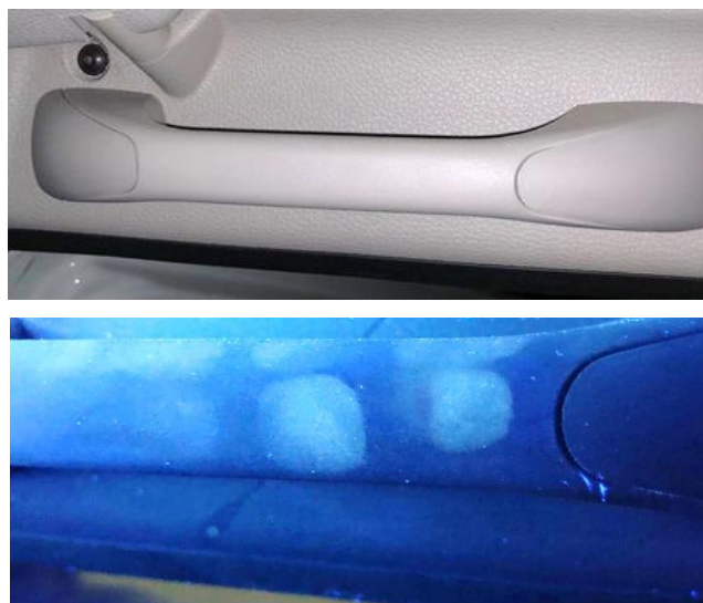
Рис. 4.2. Результат применения комплекса «SVX-K»: сверху – следы в обычном свете, снизу – визуализация в УФ-лучах (материал – обшивка двери Лада Ларгус)
