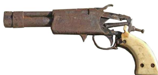
Рис. 7.8. Самодельный пистолет с качающимся стволом, запираемом щитком рамки (изготовлен с использованием колодки охотничьего ружья)
