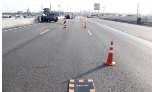
Рис. 5.10. Метрическая съемка с глубинным квадратным масштабом со стороной 0,5 м (на переднем плане)
