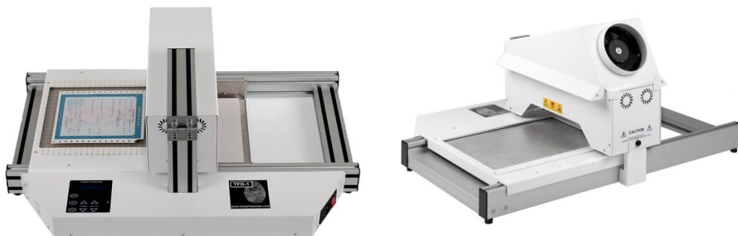
Рис. 19.3. Автоматизированный комплекс для теплового выявления и визуализации скрытых следов рук TFD-2, использующий принципиально новую технологию выявления следов на бумажных документах, не требует химических реагентов
