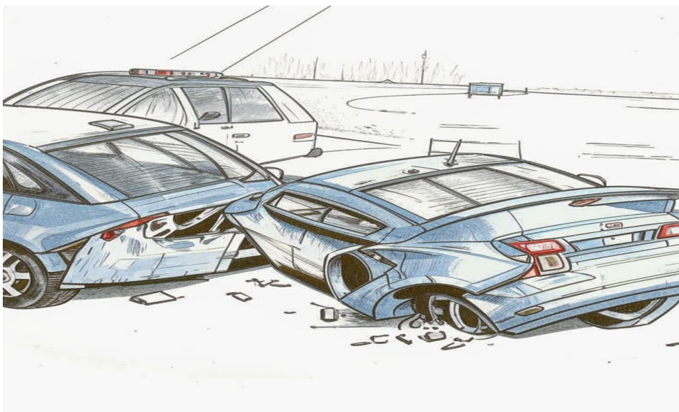
Рис. 2. Заднее столкновение автомобилей, при котором оба автомобиля передвигаются с места столкновения
