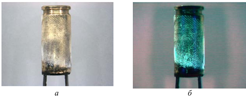
Рис. 4.8. а – след, выявленный на поверхности гильзы после обработки цианакрилатом; б – его последующая обработка флуоресцентным красителем Ardrox с фиксацией в УФ области спектра
