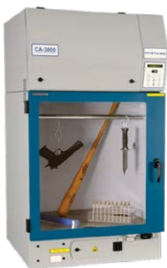
Рис. 4.6. Лабораторные камеры для выявления следов рук парами цианакрилата: а – камера FR200; б – камера CA-3000; в – камера CA-9000 1
