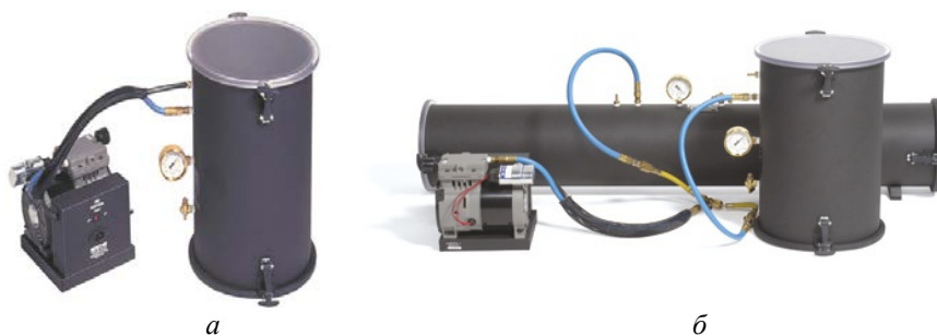
Рис. 4.7. Вакуумные камеры для выявления следов рук парами цианакрилата: а – камера VAC150; б – камера VAC350 (используется для обнаружения невидимых следов рук на объектах, находящихся внутри пакетов, под самоклеящимися пленками и на алюминиевой фольге)
