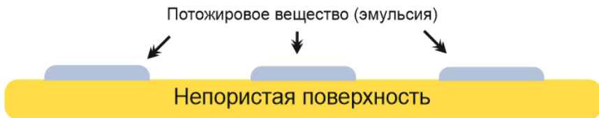
Рис. 1.4. Распределение потожирового вещества на непористой поверхности после испарения влаги
