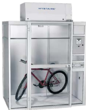
Рис. 4.6. Лабораторные камеры для выявления следов рук парами цианакрилата: а – камера FR200; б – камера CA-3000; в – камера CA-9000 1
