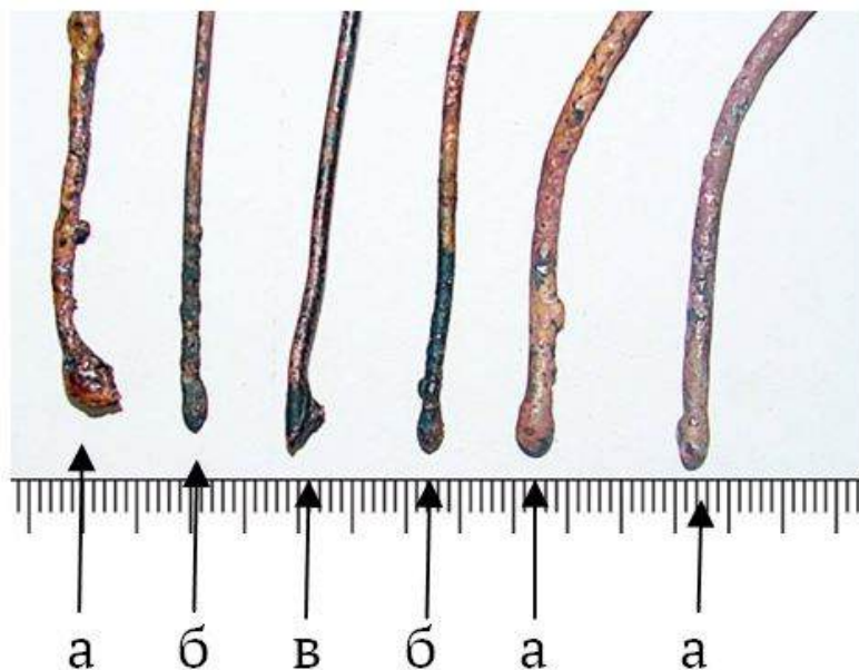
Рис. 18. Формы электродугового оплавления электропроводов (а – шарообразная; б – остроконечная; в – косой срез)
