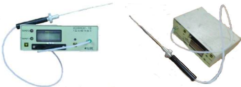
Рис. 20. Переносной фотоионизационный газоанализатор «Колион-1В»
