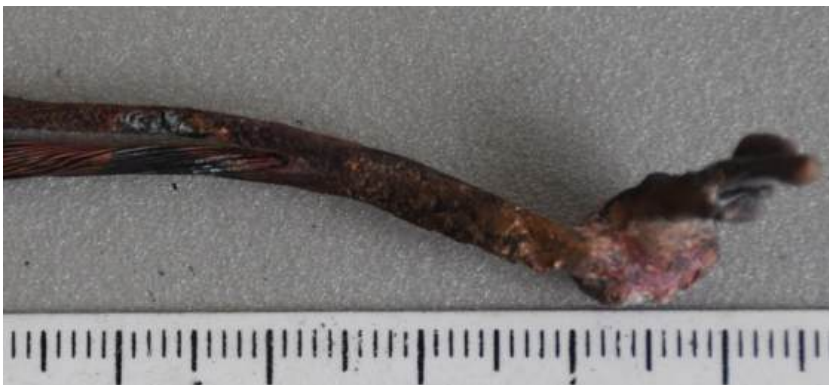
Рис. 19. Фрагмент оплавленного провода
