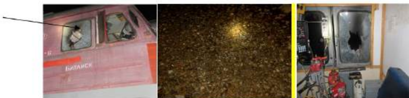
Рис. 10. Расположение осколков на земле с правой стороны от электропоезда (стрелкой черного цвета указаны следы копоти на окне)
