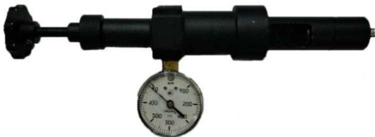
Рис. 21. Специальный гидравлический микропресс
