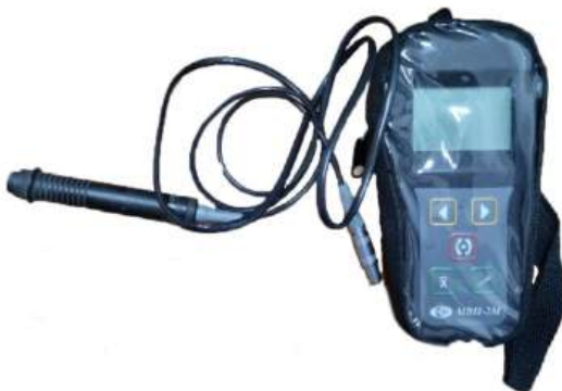
Рис. 12. Многофункциональный вихретоковый прибор МВП-2М
