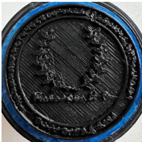
Рис. 3. Удостоверительная печатная форма, изготовленная по FDM-технологии
