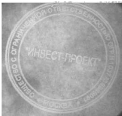
Рис. 4. Изображение оттиска печати, полученное способом монохромной струйной печати, в сине-зеленых лучах света
