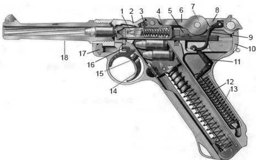
Рис. 15. Устройство пистолета Парабеллум П-08: 1 – затвор; 2 – выбрасыватель; 3 – пружина выбрасывателя; 4 – ударник с боевой пружинной; 5 – пружина шептала; 6 – шатун; 7 – ролики; 8 – мотыль; 9 – серьга; 10 – рамка; 11 – передаточный рычаг возвратного механизма; 12 – возвратная пружина; 13 – направляющая возвратной пружины; 14 – спусковой крючок; 15 – пружина спускового крючка; 16 – передаточный рычаг спускового механизма; 17 – замыкатель; 18 – ствол
