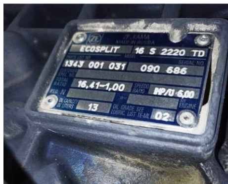
Рис. 23. МТ КПП ZF или ЦФ КАМА семейства ECOSPLIT
