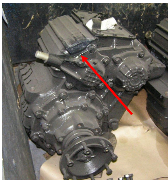
Рис. 26. Место нанесения маркировки на РК типа 4320ЯМ
