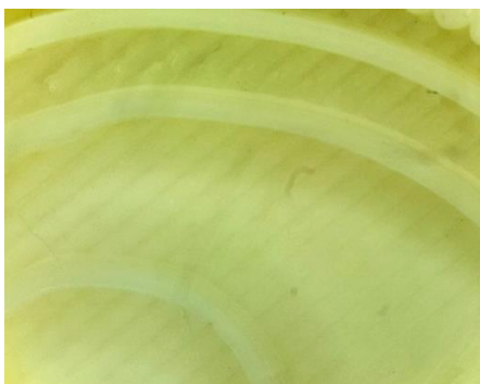
Илл. 4. Дефекты, связанные с процессом печати (искривление элементов) (микроскоп МСП-1 ув. До 50х)
