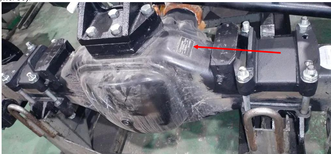
Рис. 30. Место установки МТ на корпусе ведущего моста производства Shaanxi HanDe Axle
