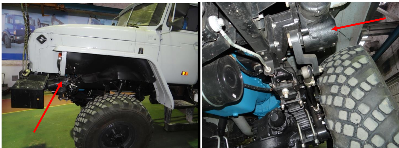
а б Рис. 16 а, б. Место установки механизма рулевого управления на автомобилях УРАЛ
