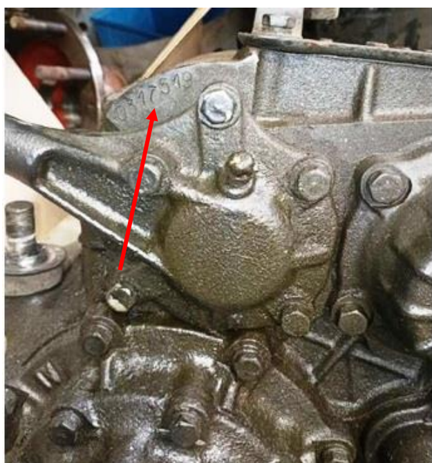
Рис. 26. Место нанесения маркировки на РК типа 4320ЯМ
