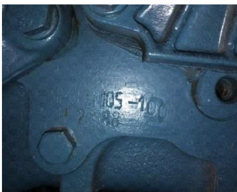
Рис. 21. Маркировка КПП без демультипликатором
