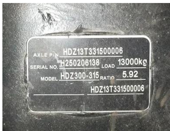
Рис. 31 а, б. МТ ведущих мостов производства Shaanxi HanDe Axle
