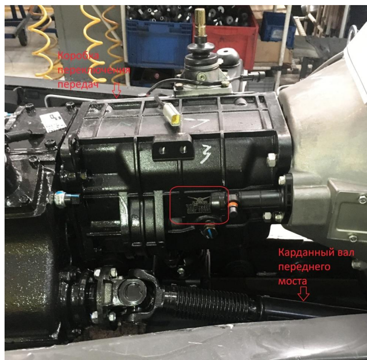
Рис. 11. КПП на шасси автомобиля УАЗ
