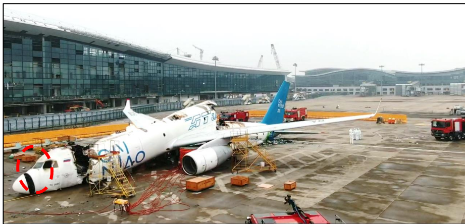
Иллюстрация 3. Вид на левый борт самолета ТУ-204С после пожара (овалом красного цвета указана зона наибольших термических разрушений)
