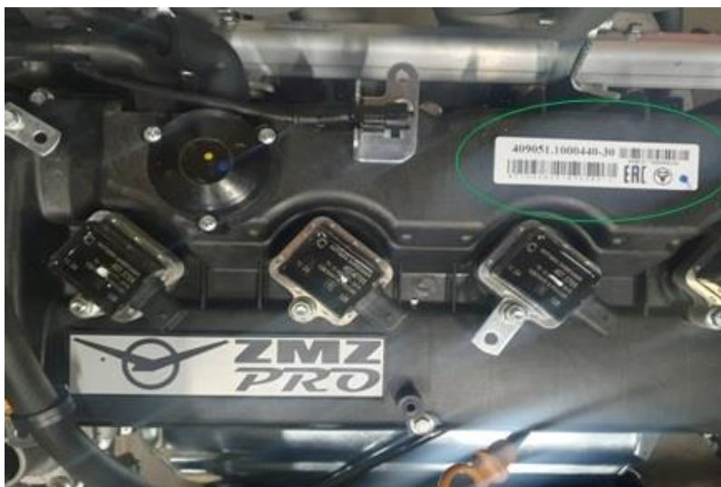
Рис. 9. Местоположение таблички заводских данных двигателя
