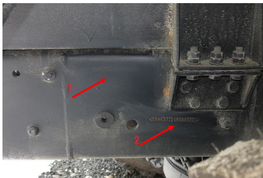
Рис. 7. Место нанесения идентификационных обозначений на раме: 1 – номер шасси ТС, присвоенный УРАЛ; 2 – VIN изготовителя конечного ТС с установленным специальным оборудованием на базе шасси УРАЛ
