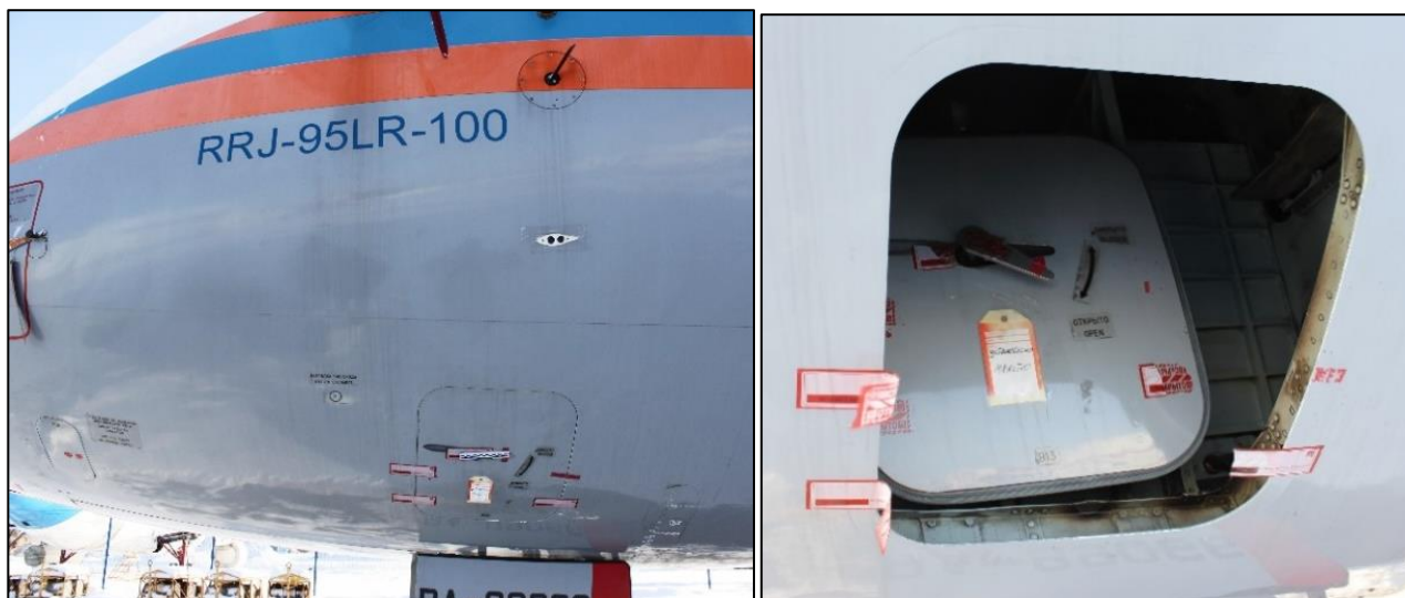
Иллюстрация 5. Вид на кислородный отсек ВС (вид с закрытым и открытым люком)
