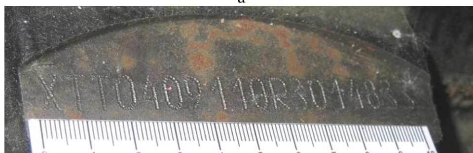
Рис. 8 а, б. Индивидуальная маркировка двигателя
