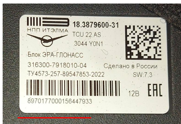
Рис. 19. Информационная табличка с ICCID на блоке УВЭОС
