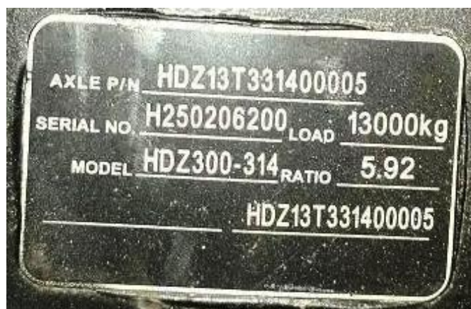
Рис. 31 а, б. МТ ведущих мостов производства Shaanxi HanDe Axle
