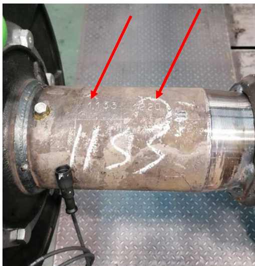
Рис. 29 а, б. Маркировка ведущего моста с указанием производственного порядкового номера, месяца и года изготовления
