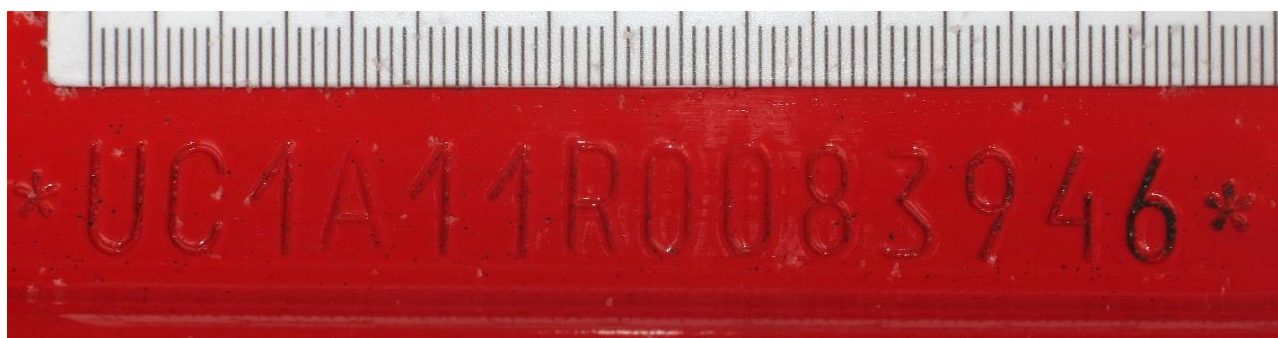
Рис. 14. Маркировка кабины NEXT
