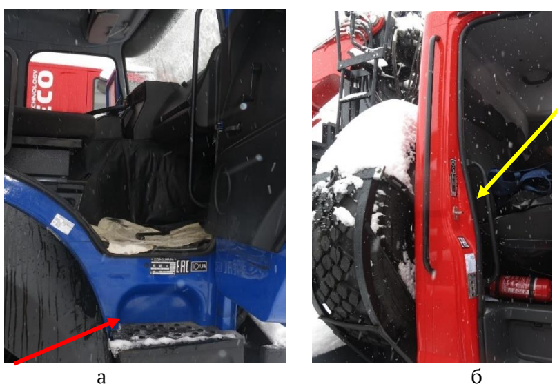
а б Рис. 11. Место установки МТ: а – на капотной кабине типа 4320 и на бескапотной кабине; б – на кабине NEXT
