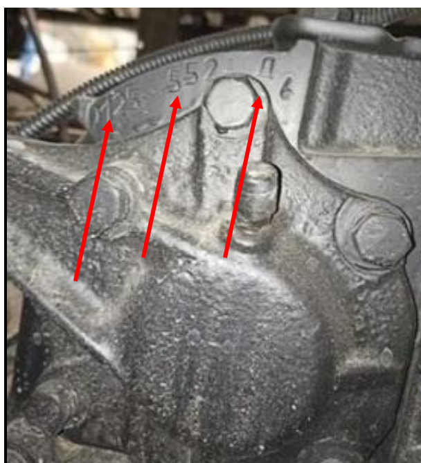
Рис. 26. Место нанесения маркировки на РК типа 4320ЯМ
