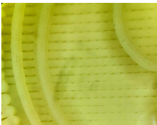
Илл. 2. Слоистость в виде горизонтальных слоев (микроскоп МСП-1 ув. До 50х)
