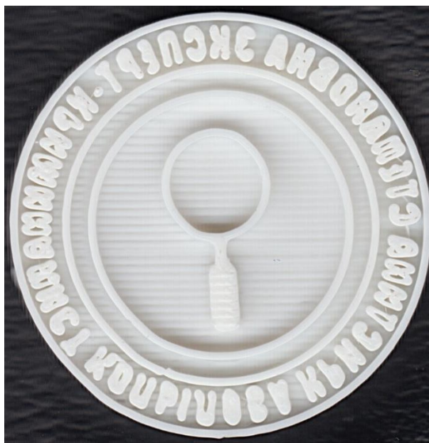
Илл. 1. Рабочая поверхность удостоверительной печатной формы, полученной с помощью 3D-печати
