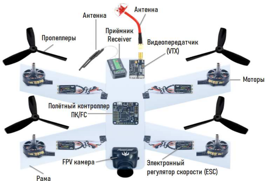
Рис. 14. Расположение отдельных элементов радиоэлектронного оборудования управления и навигации БВС мультироторного типа 1
