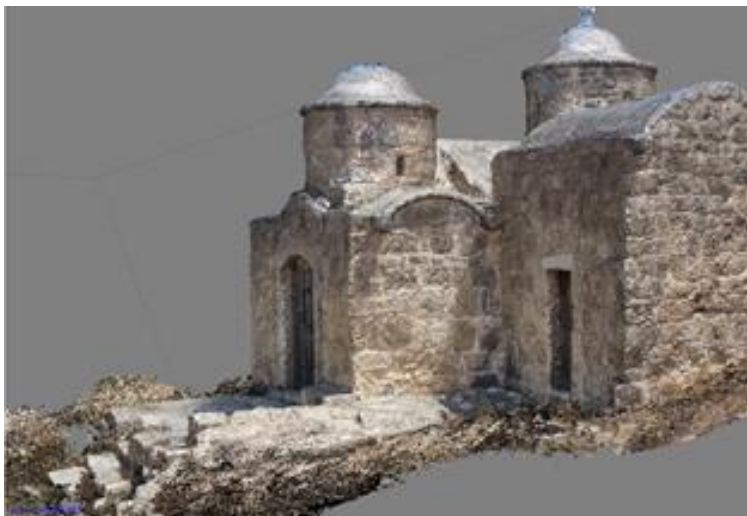
Рис. 1.15. 3D-модель церкви Айя Марина, полученная с помощью фотограмметрии
