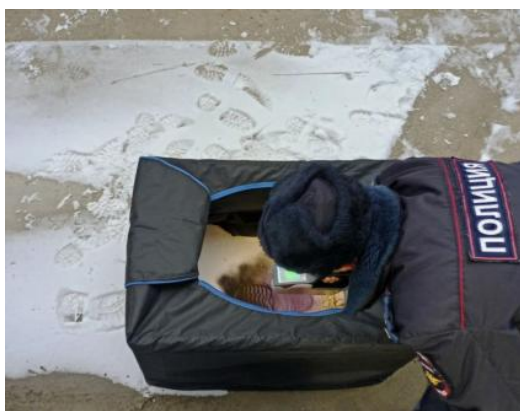
Рис. 3.24. Процесс сканирования следа обуви на поверхности рыхлого снега и его трехмерная полигональная модель
