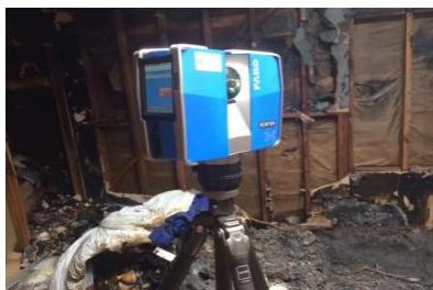
Рис. 1.35. Использование лазерных 3D-сканеров Leica RTC360 (а) 1 , FARO Focus S350 (б) 2 и Trimble X7 (в) 3 для фиксации обстановки на месте происшествия с целью документирования следовой информации и создания трехмерной модели сцены
