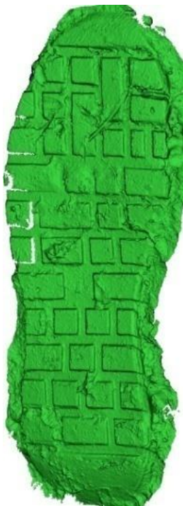
Рис. 3.21. Полигональная модель объемного следа подошвы обуви, полученная с помощью сканера Calibry Mini в темное время суток
