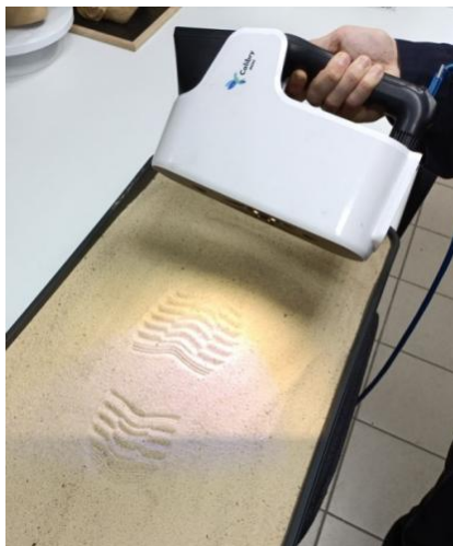
Рис. 3.5. Расположение сканера относительно следа: а – перпендикулярно; б – под углом 45–60 градусов относительно следа
