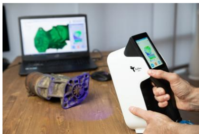
Рис. 1.28. Процесс получения поверхностной трехмерной модели детали с помощью сканера Calibry Mini, основанного на принципе использования структурированного света
