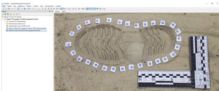
Рис. 2.9. Плотное облако точек, построенное в Agisoft Metashape после выравнивания изображений
