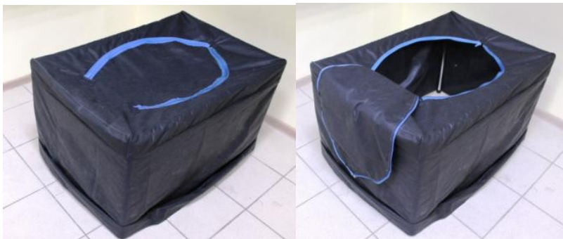
Рис. 3.18. Каркас с чехлом затемняющего столика для 3D-сканирования
