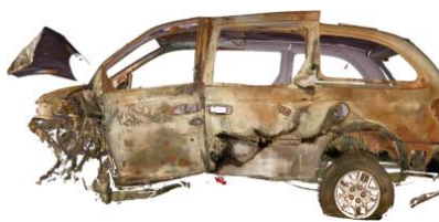
Рис. 1.8. 3D-модель транспортного средства с повреждениями
