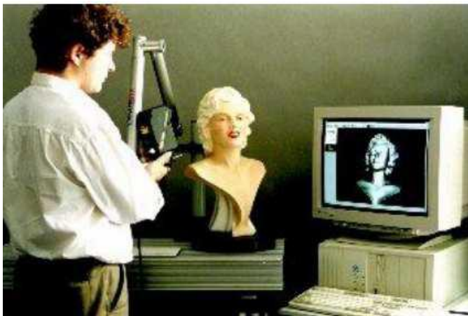
Рис. 1.5. Процесс цифрового захвата формы и текстуры головы манекена с помощью ручного лазерного 3D-сканера
