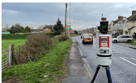
Рис. 1.35. Использование лазерных 3D-сканеров Leica RTC360 (а) 1 , FARO Focus S350 (б) 2 и Trimble X7 (в) 3 для фиксации обстановки на месте происшествия с целью документирования следовой информации и создания трехмерной модели сцены
