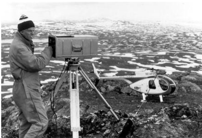
Рис. 1.3. Использование геодезического лазерного дальномера AGA Geodimeter modell 8 при изысканиях в районах крайнего севера
