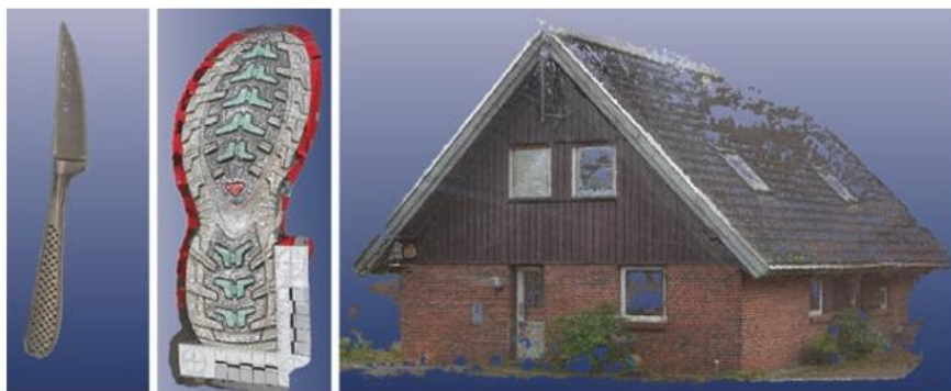
Рис. 1.25. Пример 3D-моделей оружия, подошвы обуви и здания, полученных с использованием фотограмметрии
