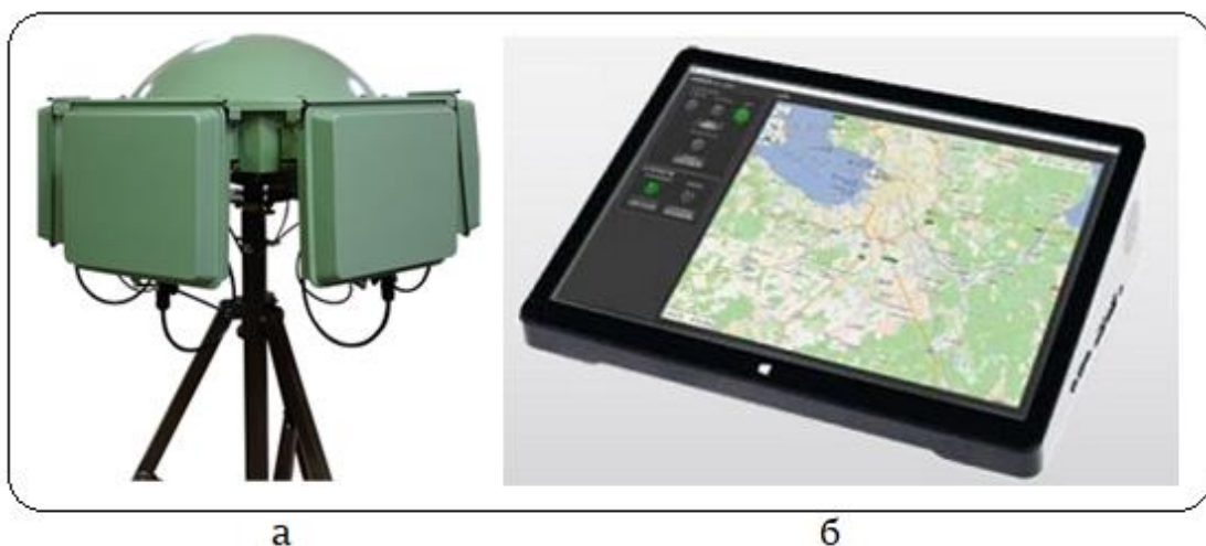
Рис. 30. Основные элементы комплекса «Стриж-3»: а – приемопередающая антенна; б – портативный пульт управления
