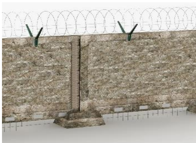
Рис. 2. Каменное ограждение с дополнительными верхним и нижним ограждениями
