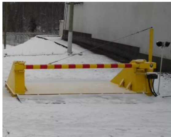
б) противотаранное устройство шлагбаумного типа
