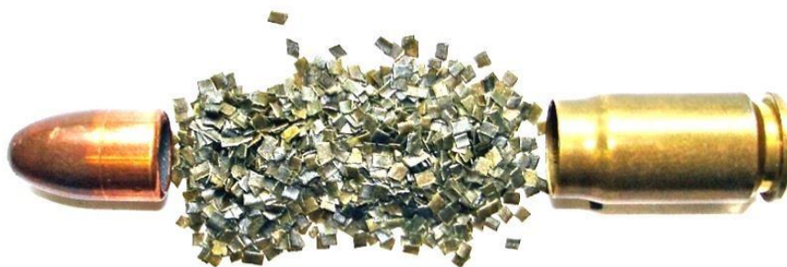
Рис. 7. Использование пороха «Сокол» для снаряжения пистолетного патрона калибра .357 SIG
