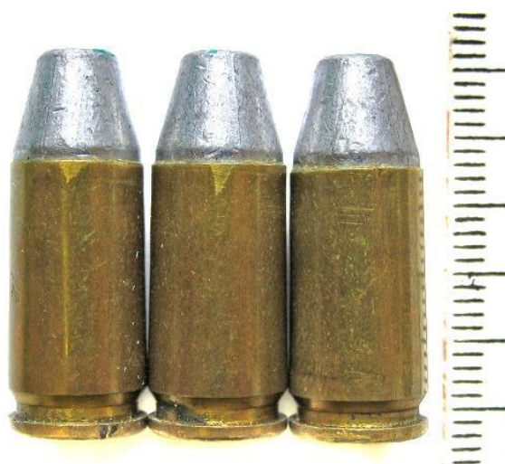
Рис. 9. 9-мм патроны, снаряженные свинцовыми пулями, изготовленными самостоятельно
