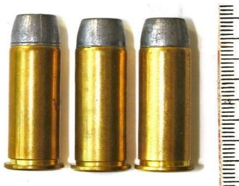
Рис. 8. Различия в глубине посадки пуль в гильзы
