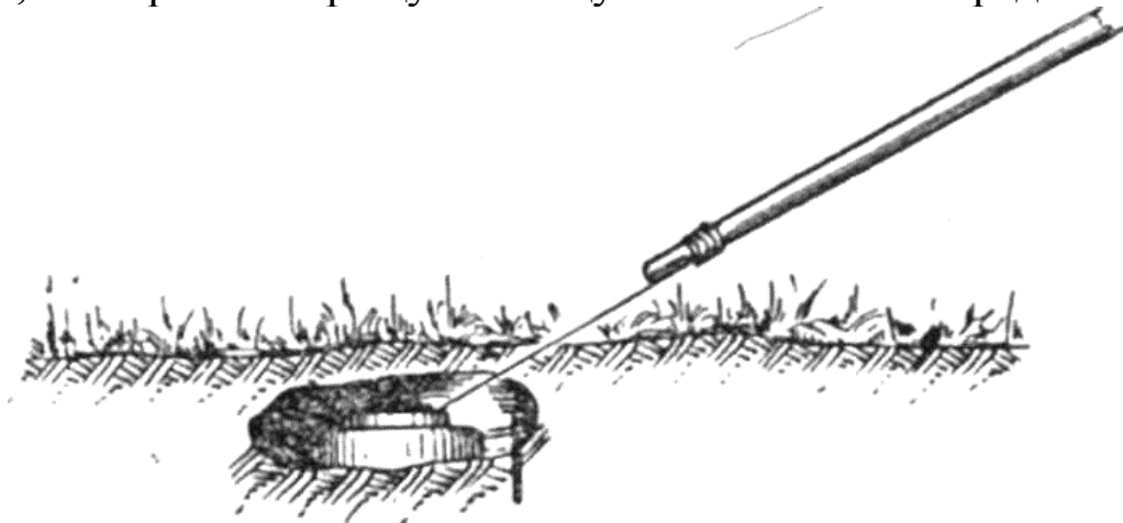
Положение щупа при поиске мин
