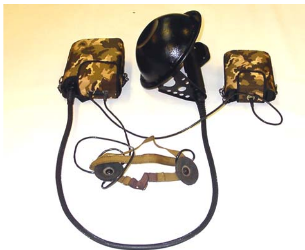
Общий вид нелинейного радиолокатора НР 900К
