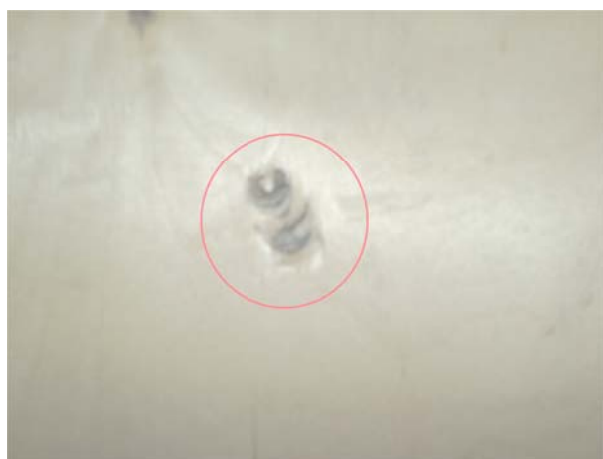
Рис. 48. След в фанере толщиной 10 мм от попадания пули ООП «Оса»
