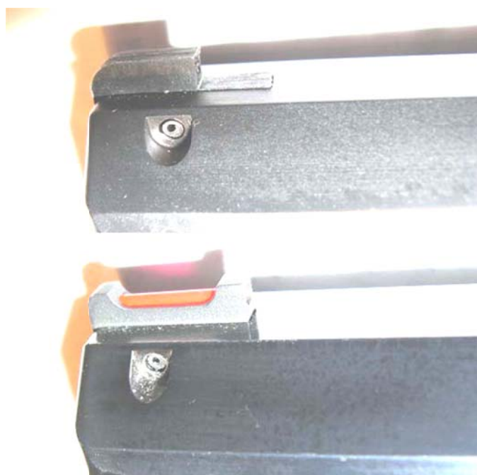
Рис. 24. Мушки: стандартная (сверху) и свето-волоконная
