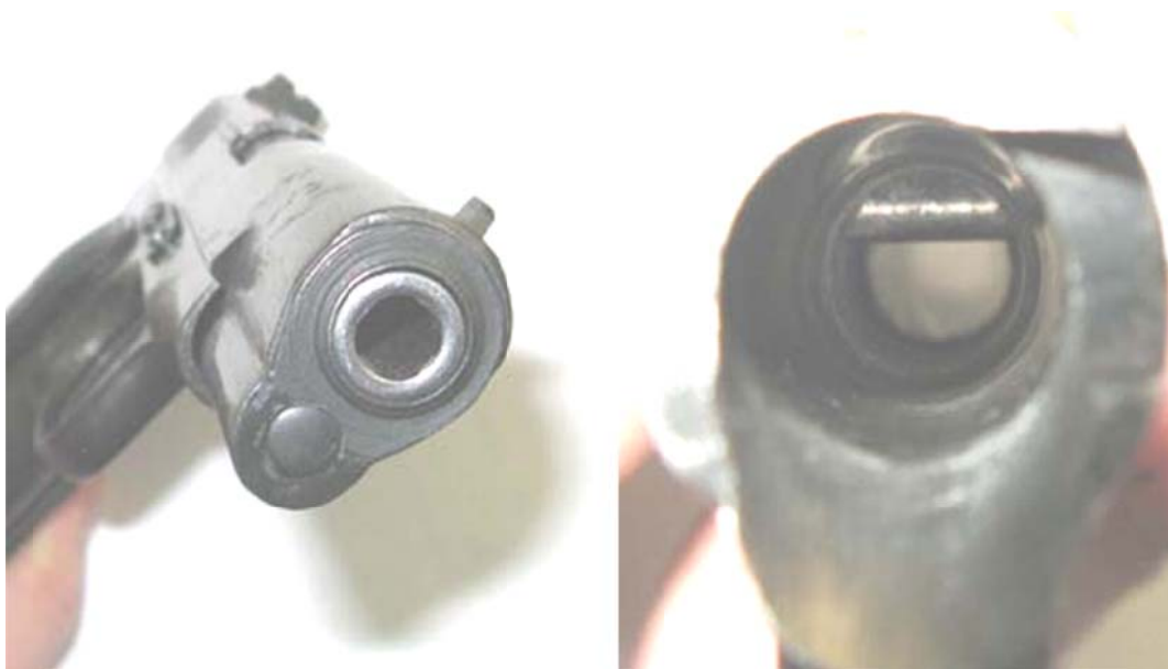
Рис. 8. Дульный и казенный срезы ствола ТТ-Т
