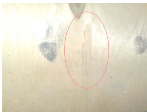
Рис. 49. Отслоение материала с обратной стороны фанеры толщиной 10 см при попадании пули ООП «Оса»
