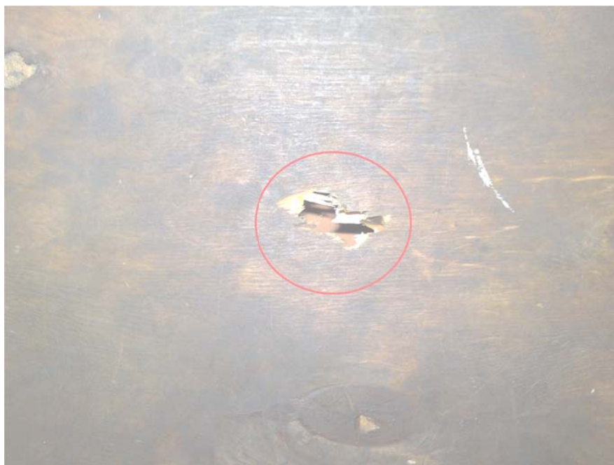
Рис. 47. Отверстие в фанере толщиной 6 мм при выстреле с дистанции 2 м
