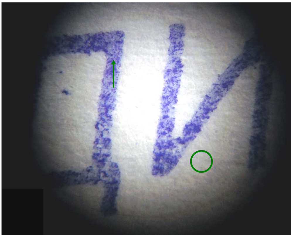
Рис. 6. Диагностические признаки фотополимерных печатей.
