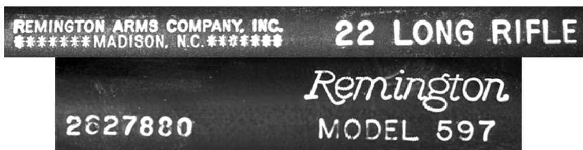
Рис. 2. Маркировочные обозначения на стволе и ствольной коробке карабина Remington модели 597 калибра .22 LR.
