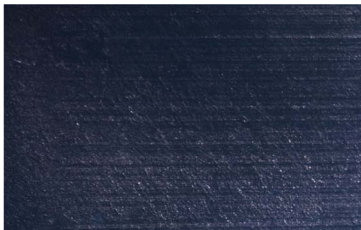
Рис. 3. Следы внутренней поверхности канала ствола на слепках с пыж-контейнера.
