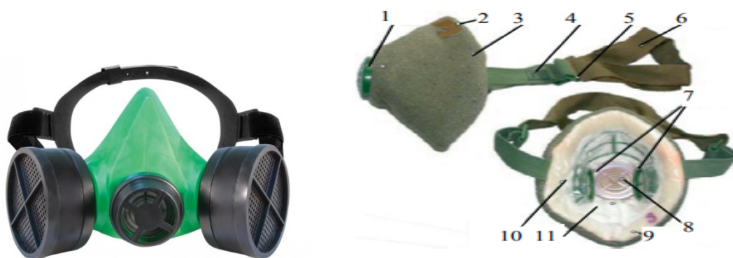
Рис. 6.50. Противопылевые респираторы Исток – 400 (РУ-60М) (слева) и Р-2. 1, 8 – клапан выдоха; 2 – носовой зажим; 3 – полумаска; 4 – эластичные тесемки; 5 – регулятор размера оголовка (пряжка); 6 - нерастягивающиеся тесемки; 7 – клапаны вдоха; 9, 10, 11 – слои соответственно: внешний, фильтрующий, внутренний.
