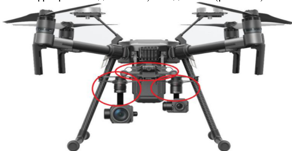
Рис. 6.84. Разновидность карданного подвеса
