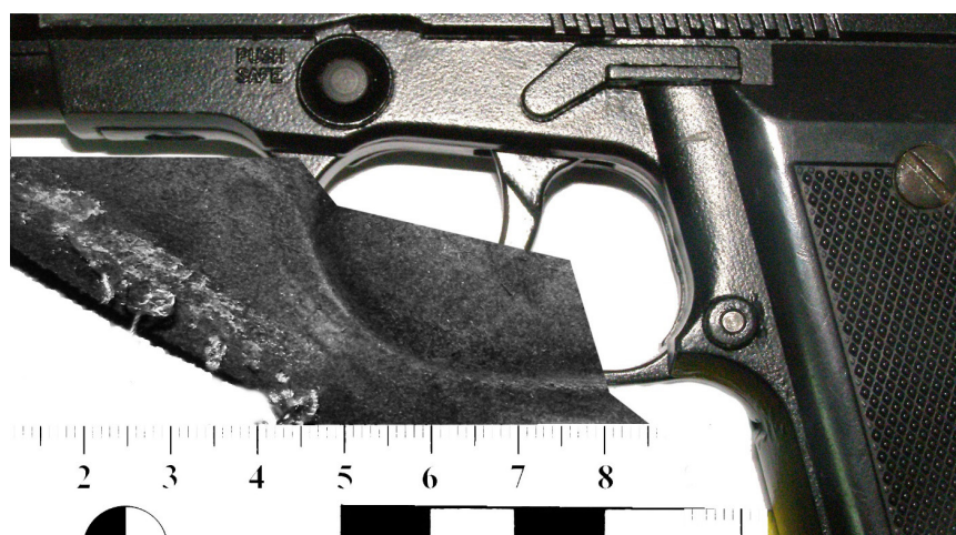
Рис. 5. Увеличенный фотоснимок совмещения спусковой скобы, спускового крючка пистолета модели «А-101», представленного на исследование, и локального следа предмета размером 75×44 мм, обнаруженного на внутренней поверхности кобуры
