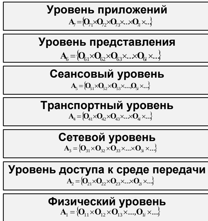
Рис. 6. Обобщенная теоретико-множественная модель структуры АИС
