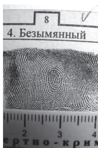
Рис. 5. Изображение следа, полученное с использованием фотоаппарата Canon EOS 5 D с тремя удлинительными кольцами Kenko и объективом Canon EF 50mm f/1.8
